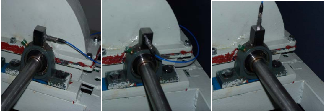
Şekil 4.4 İvmemetre Sensörü İle Üç Boyutta(x,y,z) Veri Alımı
