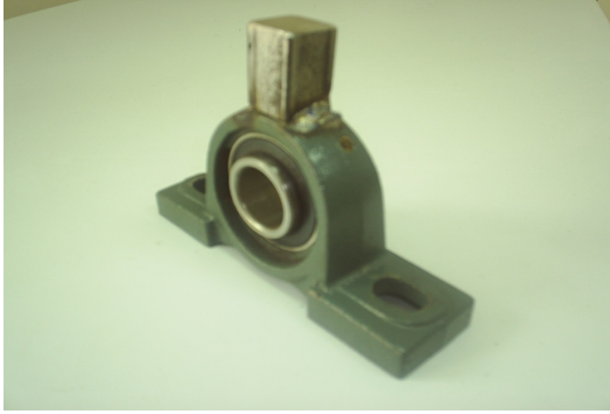
Şekil 4.3 Üzerine Küp Parça Kaynatılmış Rulmanlı Yatak
