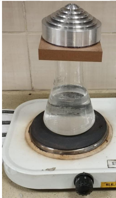
Şekil 3.6. Su buharına mukavemet testi
