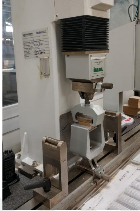
Şekil 3.5. Yüzeye dik çekme direnci testi
