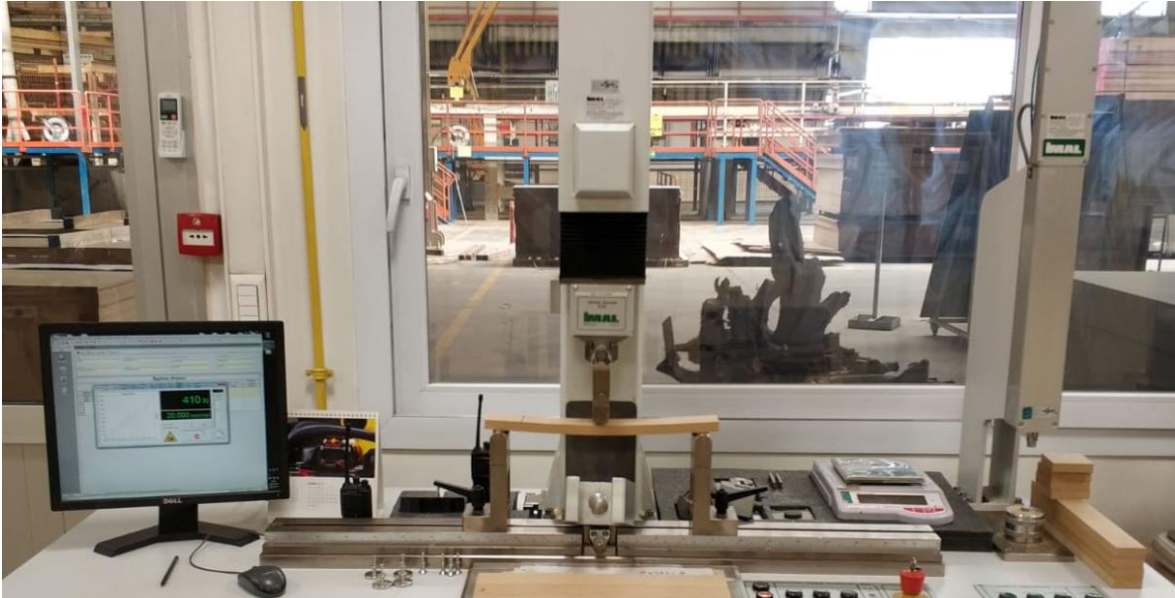
Şekil 3.4. Eğilme direnci testi
