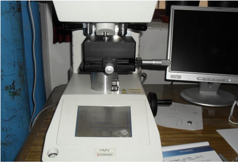
Şekil 4.13 Vickers Ölçme Deney Düzeneği
