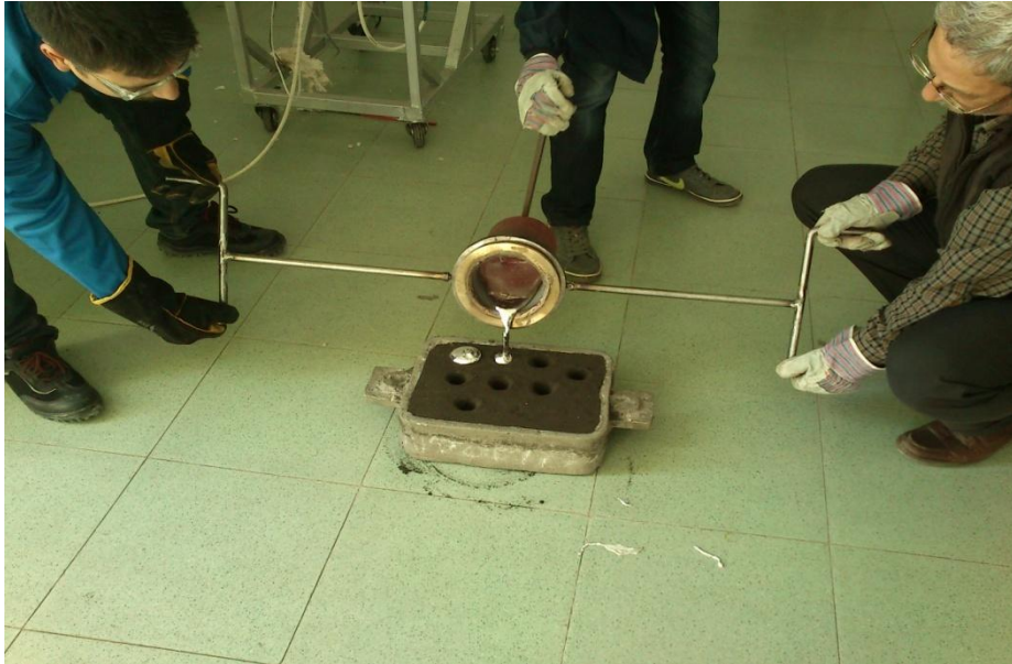
Şekil 4.11 Deney Numunelerinin Kum Kalıba Dökümü
