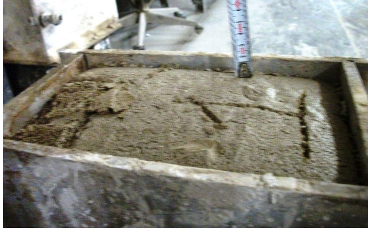
Şekil 3.9. Gazbeton keki otoklava koymadan önce
