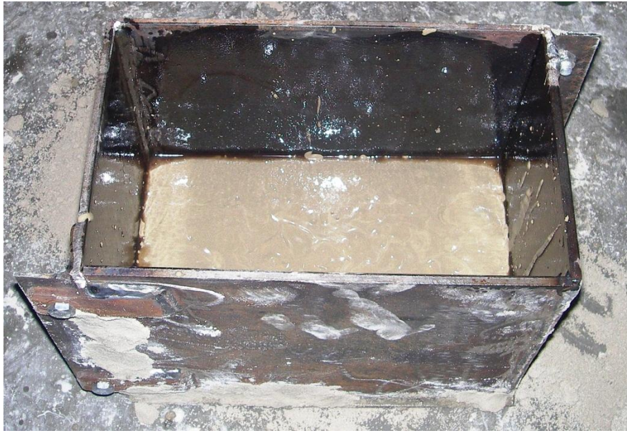
Şekil 3.7. Sulu kıvamda gazbeton, kabarmaya başlamadan önce
