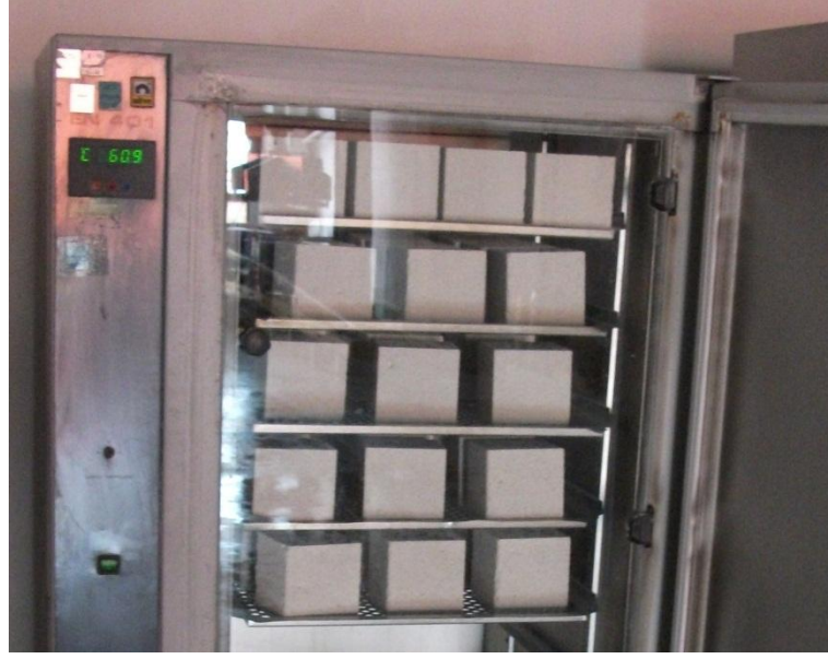
Şekil 3.13. Basınç testi için gerekli olan numunelerin etüvdeki görüntüsü.
