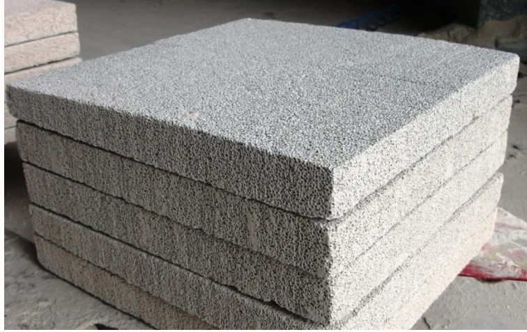
Şekil 3.12. Isıl iletkenlik testi için kesilen numuneler
