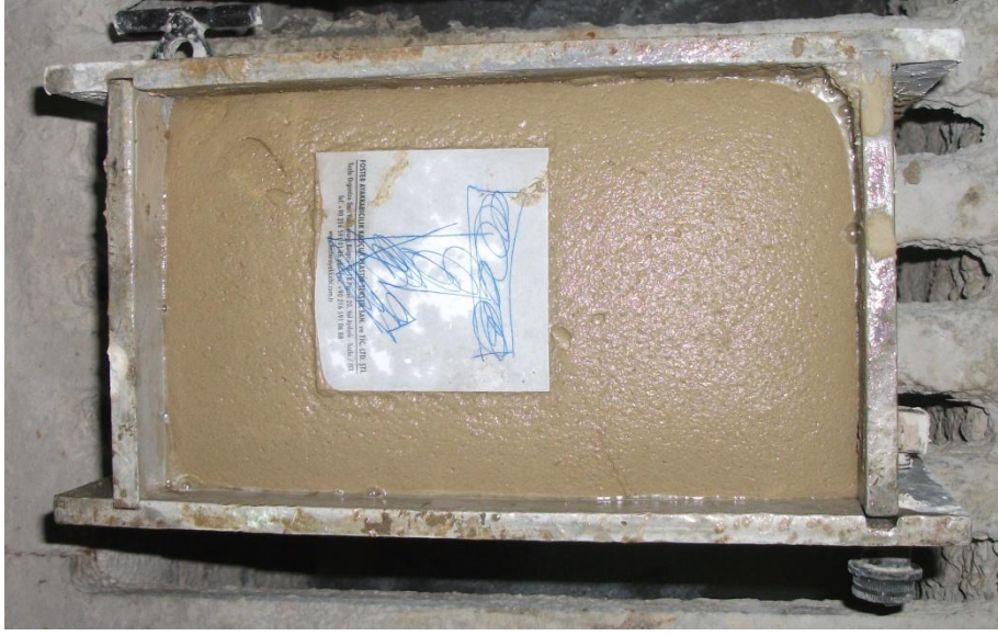
Şekil 3.8. Gazbeton harcının kabarmış hali
