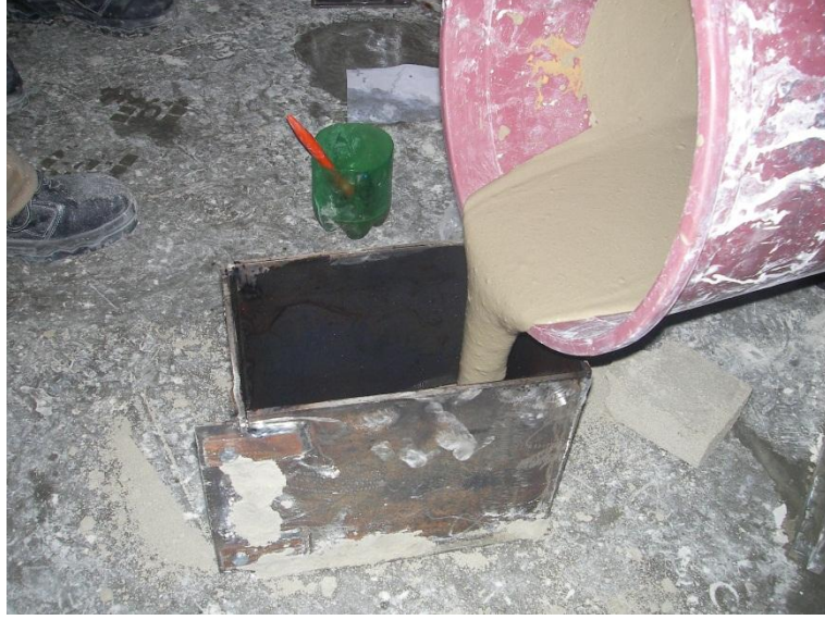
Şekil 3.6. Karışımın numune kaplarına dökülmesi
