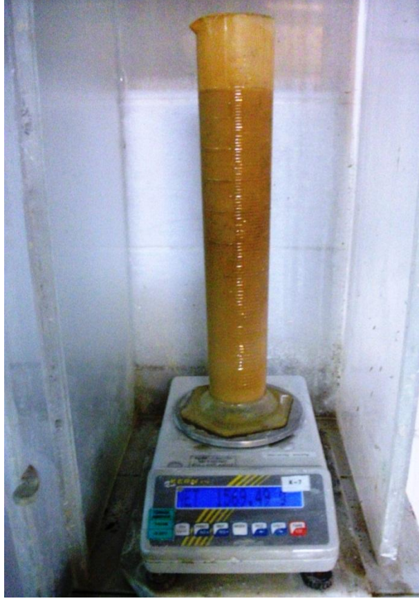
Şekil 3.2. Kum çamuru yoğunluk ölçümü
