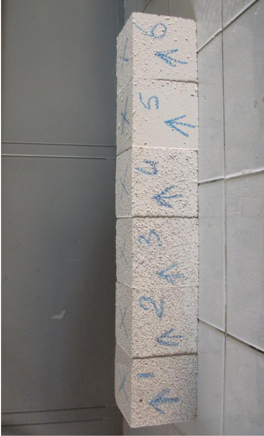
Şekil 4.6. Sepiyolit ikameli gazbeton numunelerinin dış yüzey görünüşü
