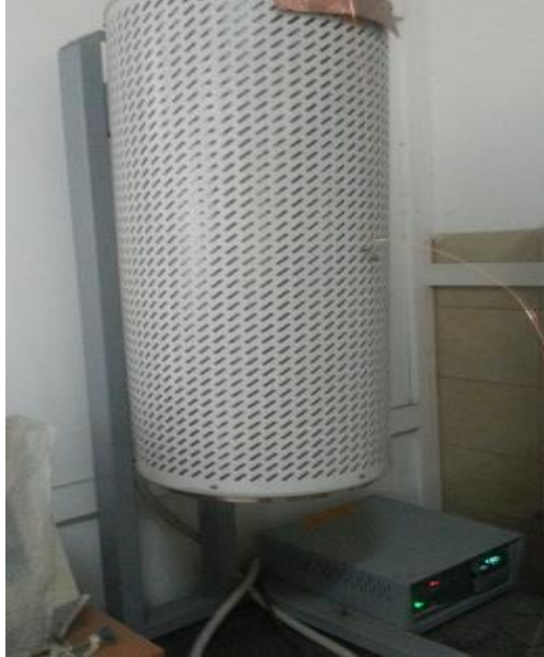
Şekil 4.8. Suni yaşlandırma işlemde kullanılan fırın
