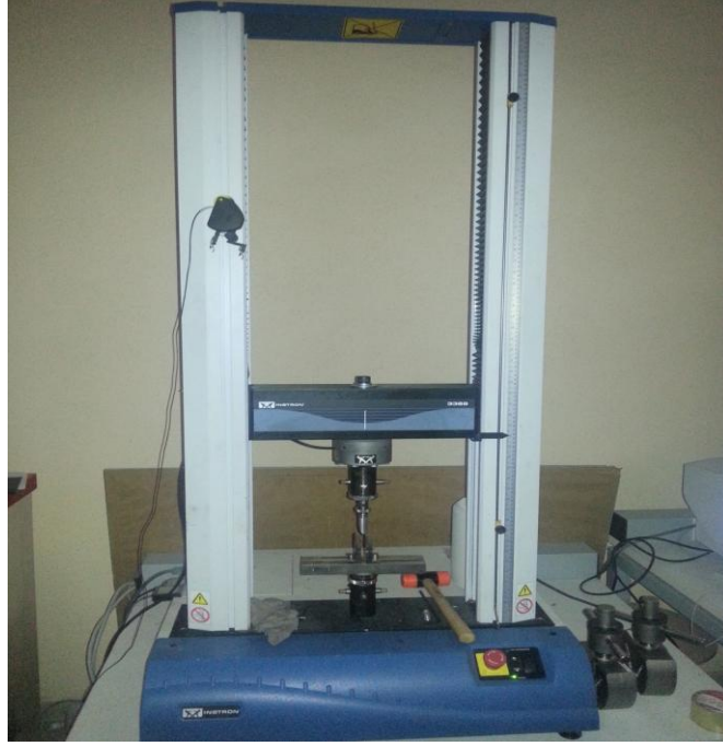
Şekil 4.10. Çapraz kırılma deneyinde kullanılan kırma cihazı
