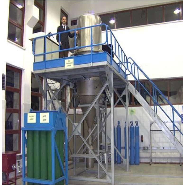
Şekil 4.2. DPU Gaz Atomizasyon Ünitesi
