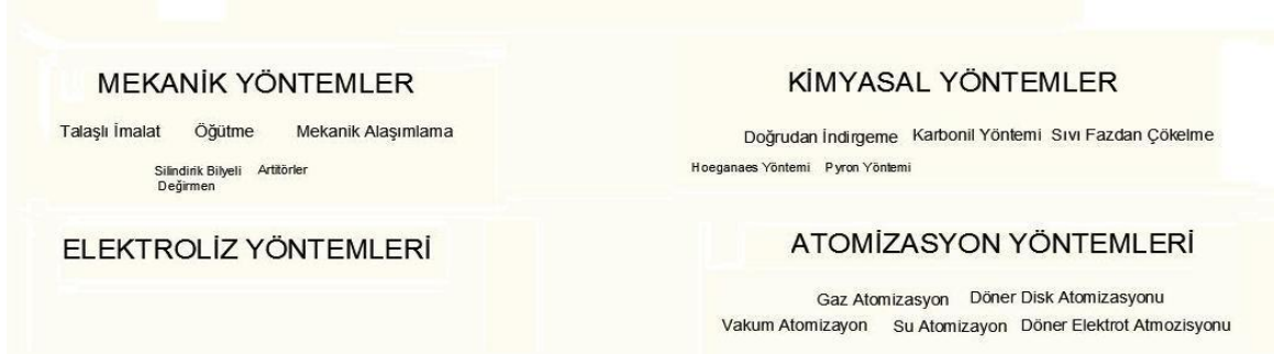
Şekil 3.2. Metal tozların üretim yöntemleri
