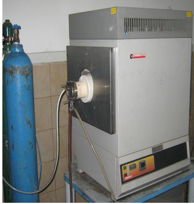
Şekil 4.6. Sinterleme işleminde kullanılan yatay tüp fırın
