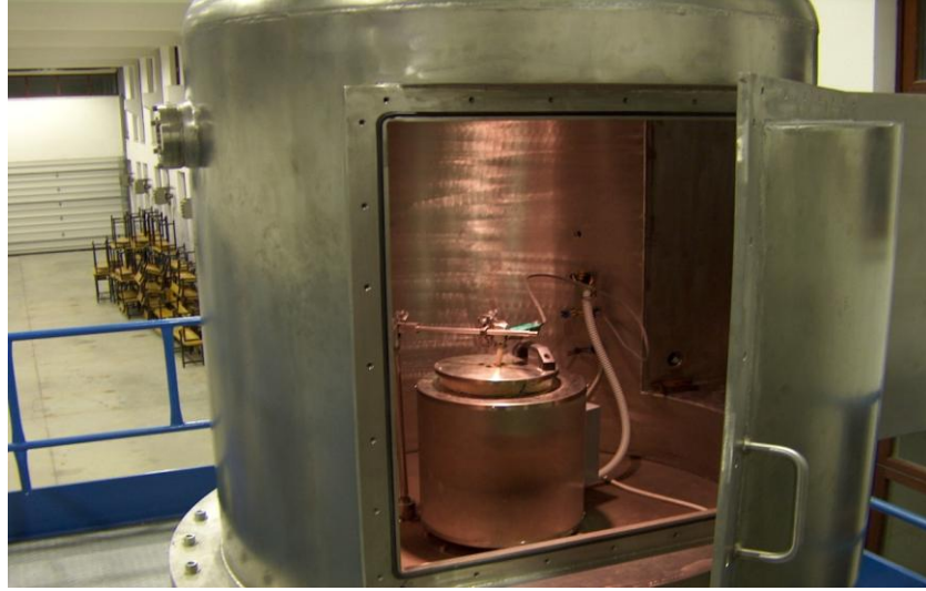
Şekil 4.1. DPU Gaz Atomizyon Ünitesi ergitme fırını
