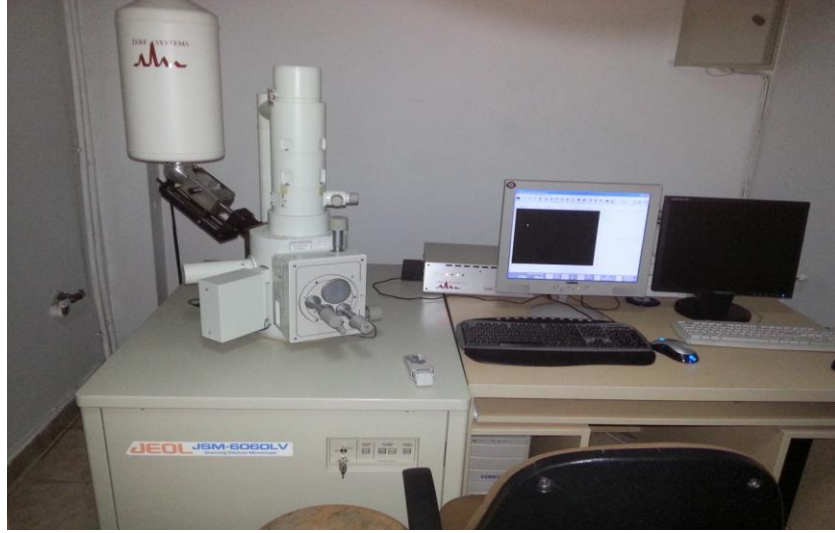
Şekil 4.13. SEM cihazının görüntüsü
