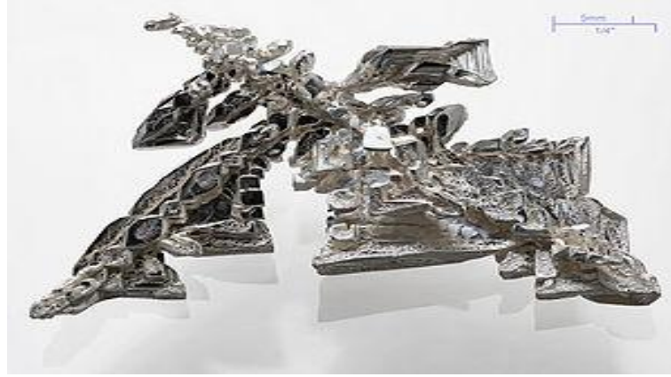
Şekil 3.6. 300 kat büyütülmüş dentritik yapıda gümüş kristali
