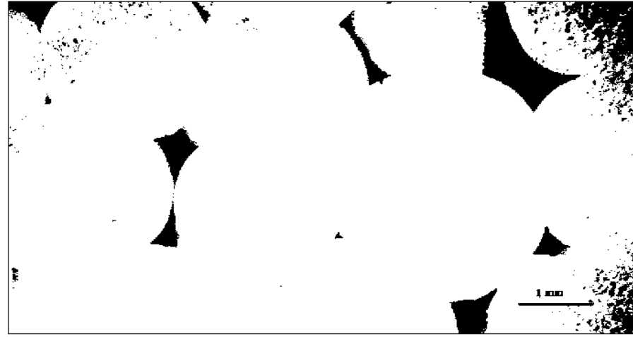
Şekil 3.9. 22 \text{ kg/m}^3 Yoğunluğa Ait Makro Yapının Görüntü Analizi
