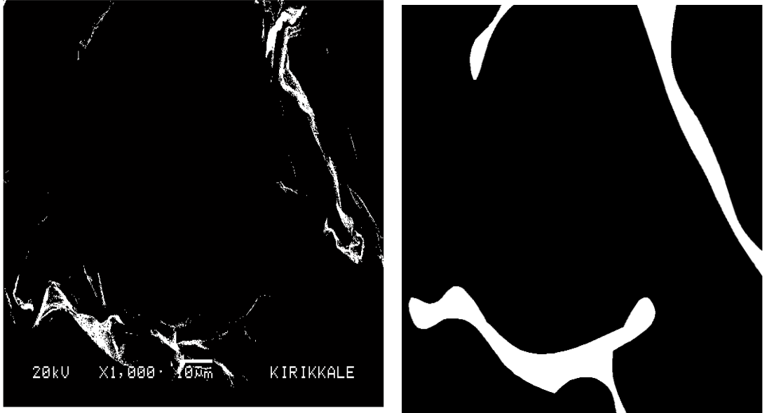
Şekil C.8. 22 kg/m 3 Yoğunluğa Sahip EPS'nin Mikro Görüntü Analizi ve Gambit Modeli
