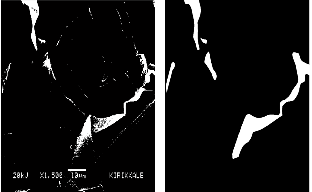
Şekil C.12. 32 kg/m 3 Yoğunluğa Sahip EPS'nin Mikro Görüntü Analizi ve Gambit Modeli
