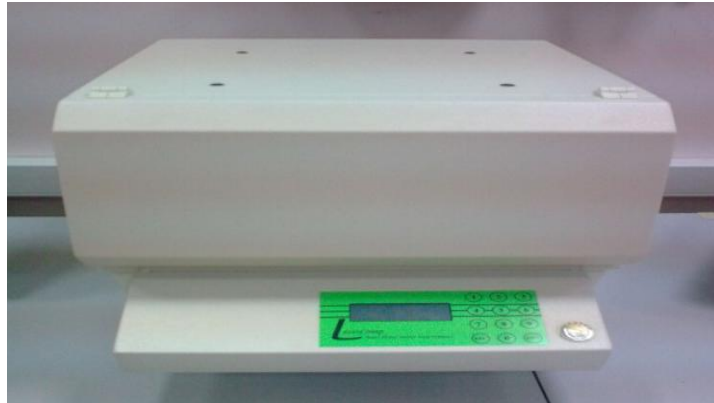
Şekil 3.39. Deneyler İçin Kullanılan Fox 314 Cihazı
