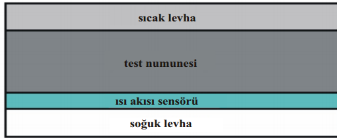
Şekil 2.28. Klasik Isı Akısı Ölçer [62]
