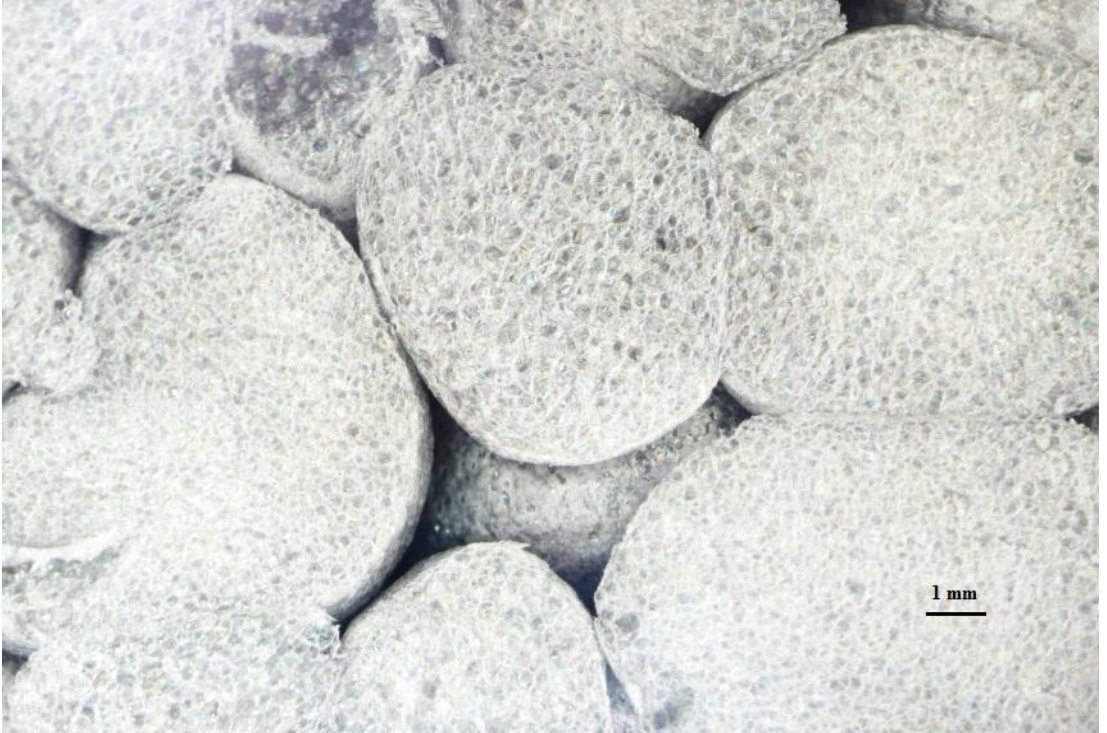
Şekil A.1. 14 \text{ kg/m}^3 Yoğunluğa Sahip Karbon Takviyeli EPS'nin Makro Görüntüsü
