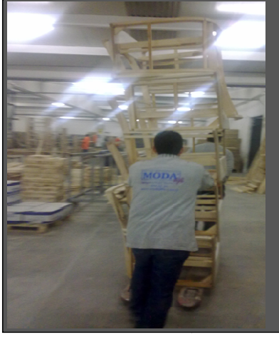
Şekil 5.7. Bölümler Arası Nakliyenin Aşırı Yükle Yapılması
