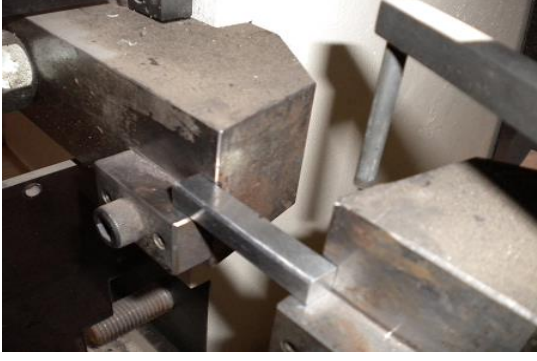
Şekil 3.7.Çentik darbe deneyinin uygulama biçimi.
