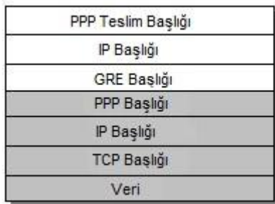
Şekil 2.35. Noktadan noktaya tünel prtokolü ile veri tünelleme işlemi
