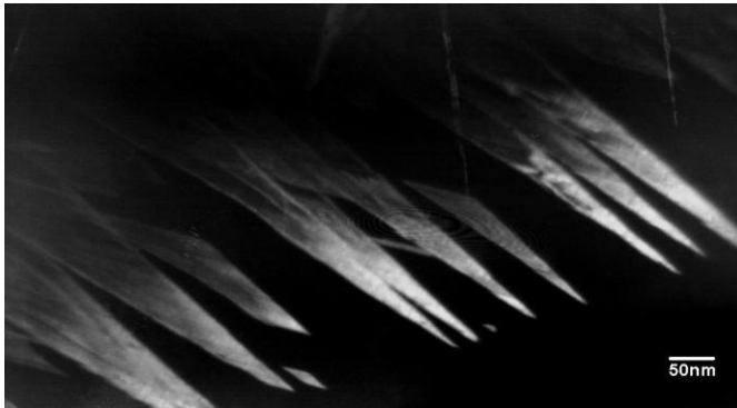
Őekil 3.12. Fe-%30Ni-%2.6Mo-%0.8Co alařımında austenite ve martensite faza ait karanlık alan grnts.
