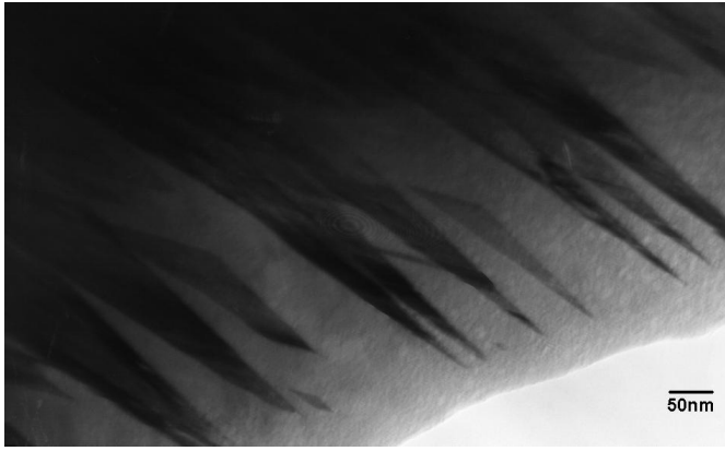
Őekil 3.11. Fe-%30Ni-%2.6Mo-%0.8Co alařımında austenite ve martensite faza ait aydınlık alan grnts.
