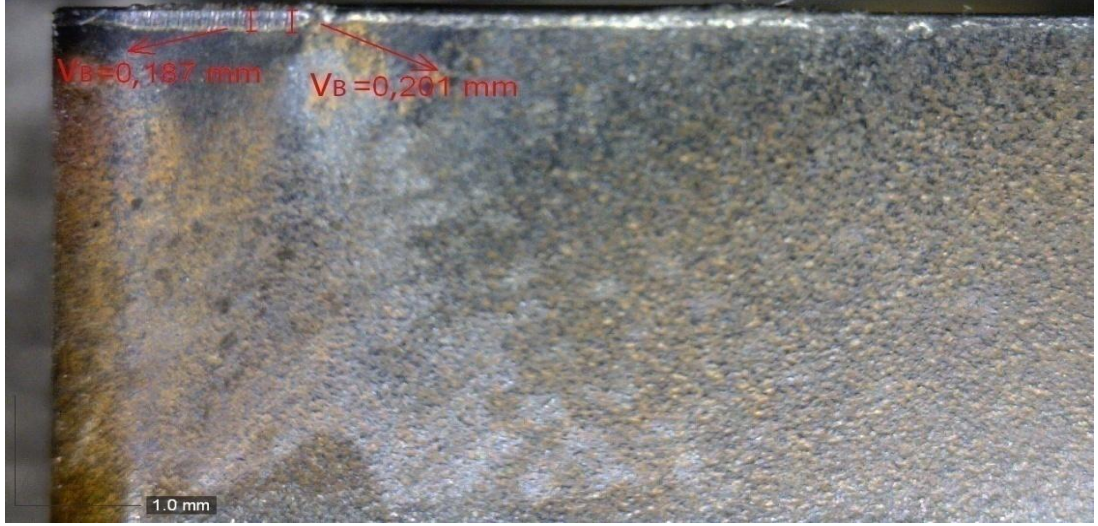
Şekil 6.2. Deney 25 kesici uç aşınması ( V_c = 400 m/dak, f = 0,1 mm/dev, ap = 2 mm)
