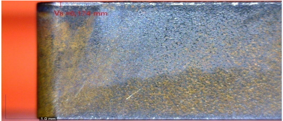
Şekil 6.1. Deney 16 kesici uç aşınması ( V_c = 400 m/dak, f = 0,1 mm/dev, a_p = 1,75 )
