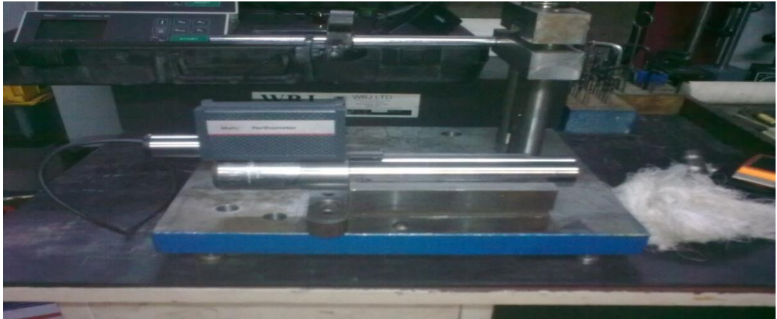
Şekil 5.2. Deney numunesinin sabitlemesi ve yüzey pürüzlülük ölçüm işlemi
