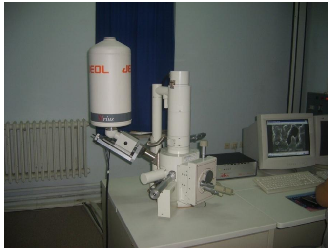
Şekil 3.19. SEM görüntüleme cihazı (Kırıkkale Üniversitesi Merkezi Araştırma Laboratuvarı)
