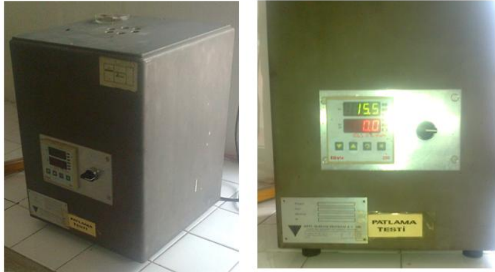
Şekil 3.17. Tutuşma (patlama) sıcaklığı tespit cihazı
