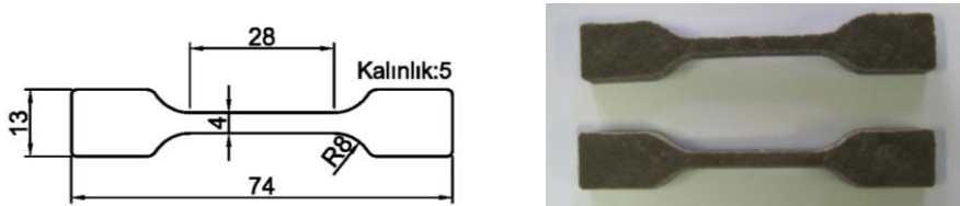
Şekil 3.34. İkinci tip çekme testi deney numunesi ölçüleri ve fotoğrafı
