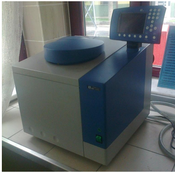
Şekil 3.13. Kapalı bomba tipi kalorimetre cihazı (MKE Barut Fabrikası)
