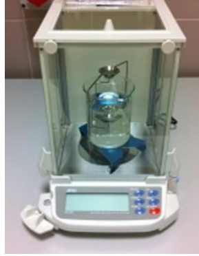
Şekil 3.12. Arşimet prensibine göre numune yakıt yoğunluk tespiti için kullanılan hassas terazi (Kırıkkale Üniversitesi)
