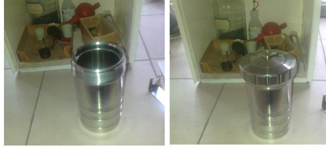
Şekil 3.14. Ölçülecek yakıt numunesinin yerleştirildiği kalorimetre kapalı bomba kısmı
