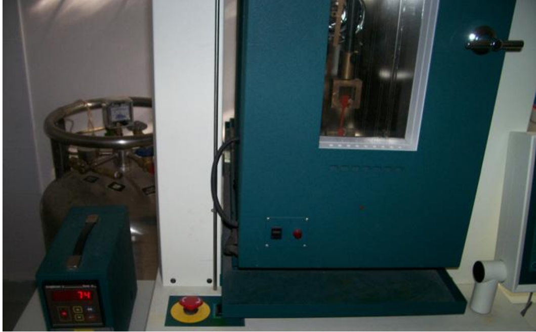
Şekil 3.36. Katı roket yakıtı mekanik davranış ölçüm cihazı
