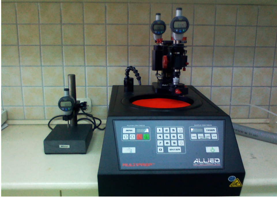
Şekil 2.16. Kırıkkale Üniversitesi bünyesine “109T129” numaralı TÜBİTAK projesi kapsamında alınan ALLIED MultiPrep inceltme ve parlatma cihazı
