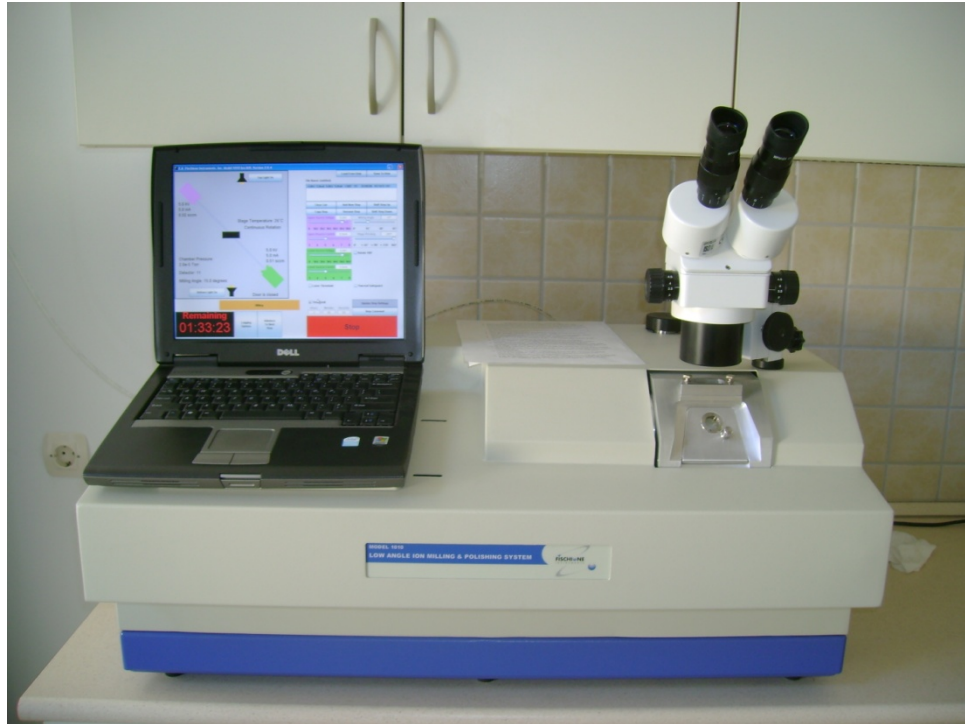
Şekil 2.17. Kırıkkale Üniversitesi bünyesine “106T043” numaralı TÜBİTAK projesi kapsamında alınan FISCHIONE Model 1010 iyon değirmeni
