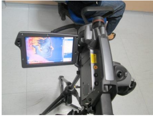
Şekil 3.2. Flir SC640 Termal kamera
