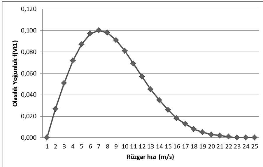
Şekil 3.51. Enercon E-48 modeli rüzgar türbini Türbin1 olasılık yoğunluk fonksiyonu f(V_{t1}) grafiği
