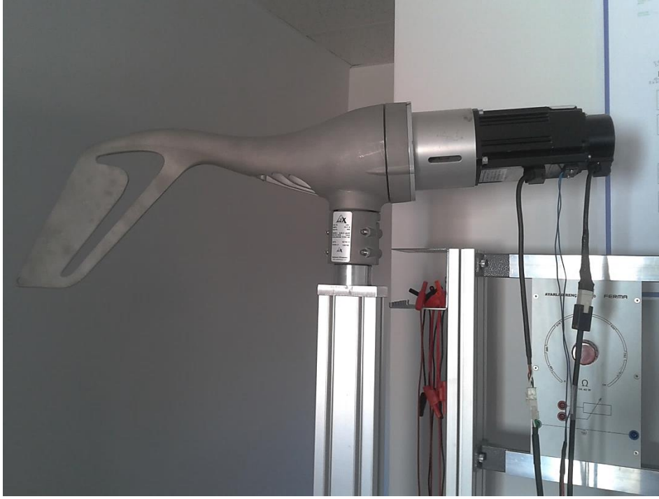
Şekil 3.3. Deney setine ait rüzgar türbini ve servo motor bağlantısı
