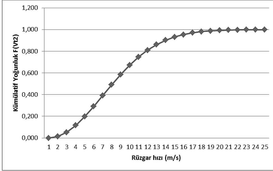
Şekil 3.37. Enercon E-48 modeli Türbin2 kümülatif yoğunluk fonksiyonu F(V_{t2}) grafiği
