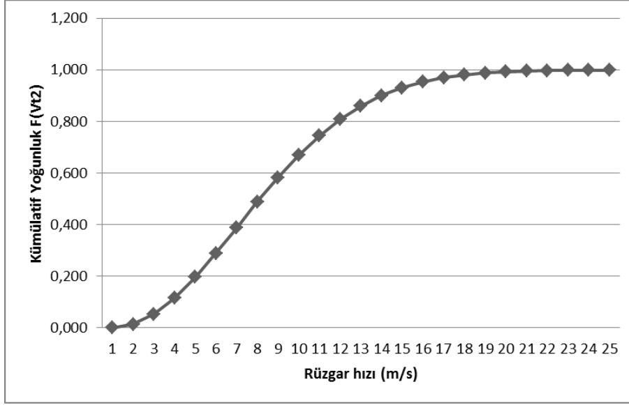
Şekil 3.55. Enercon E-53 modeli rüzgar türbini Türbin2 kümülatif yoğunluk fonksiyonu F(V_{12}) grafiği
