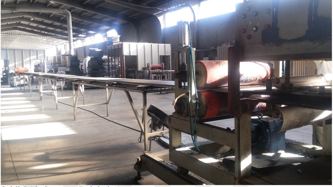
Şekil 5.10. Soğutma Rulöleri Aşaması
