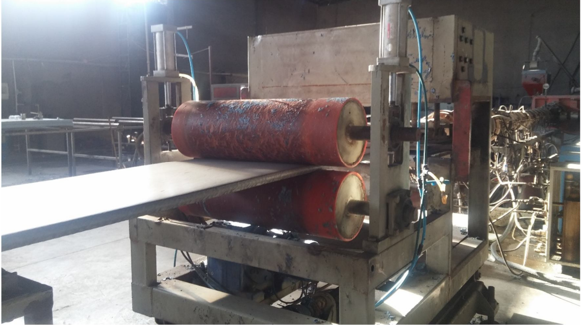
Şekil 5.9. Kalibrasyon ve Çekme Aşaması
