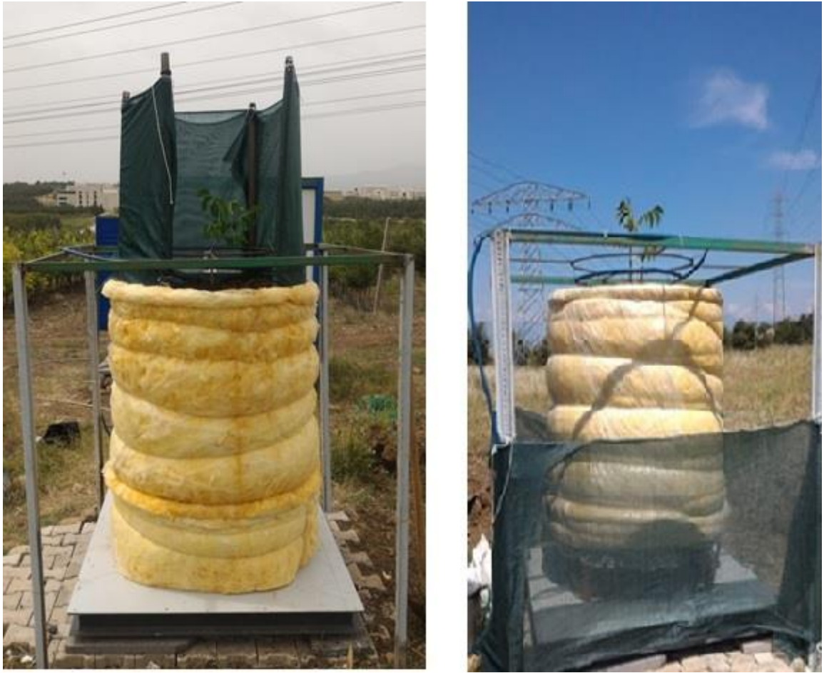
Şekil 3.5. Lizimetrenin cam yünü ile izole edilmesi, gölgelenmesi ve file gerilmesi
