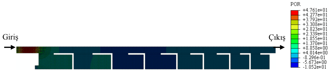
Şekil 2.66. Prototip-2 Susturucunun FEA explicit analiz sonucu akustik basınç dağılımı
