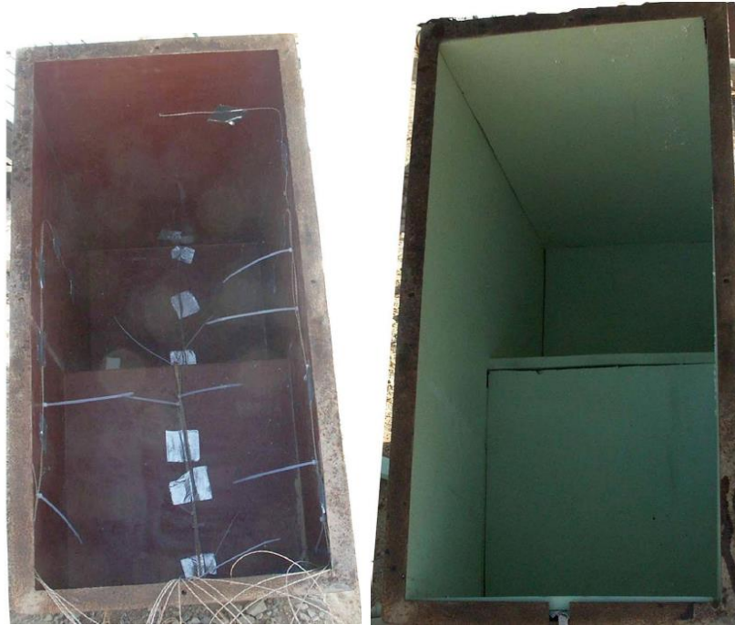
Şekil 3.33 CUBI düzeneği sıcaklık ölçer uç konumları ve kaplama gösterimi
