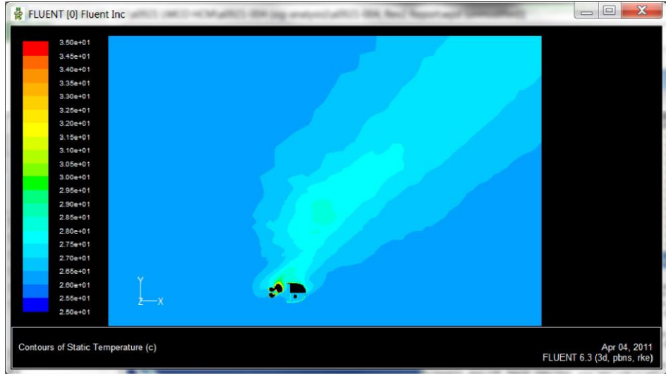
Şekil 2.8 z=13 m için xy düzlemindeki sıcaklık dağılımı
