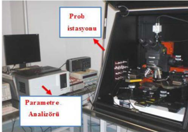
Şekil 2.32. UNAM temiz odada bulunan parametre analizörü ve prob istasyonu.
