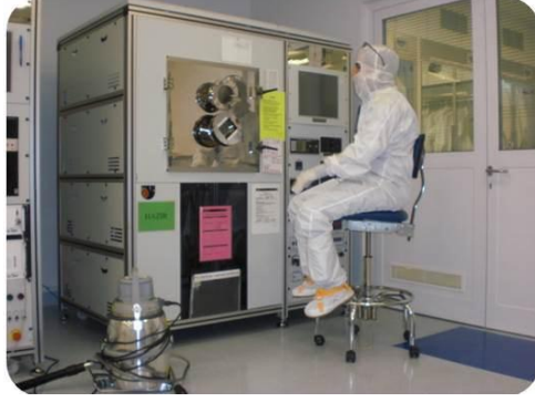
Şekil 2.4. Termal buharlaştırma sistemi.
