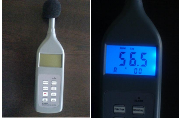
Şekil 2.9. Ölçümde kullanılan gürültü ölçüm cihazı
