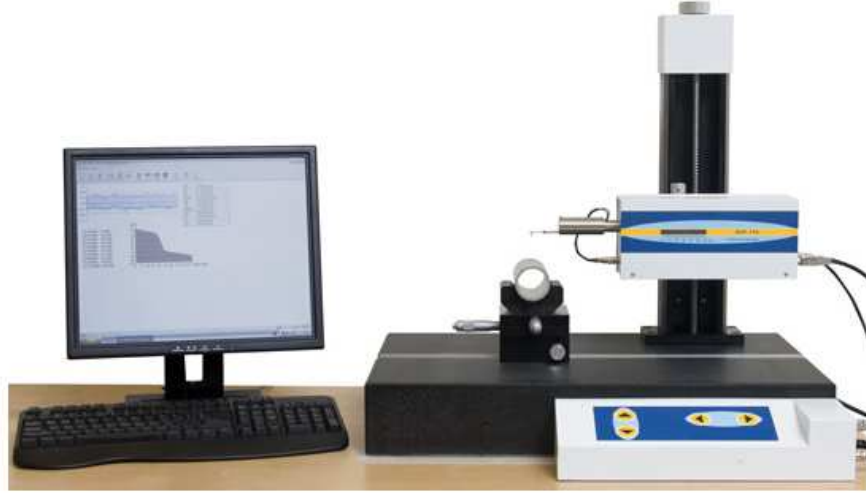
Şekil 4.14 Gelişmiş bir profilometre modeli [63]
