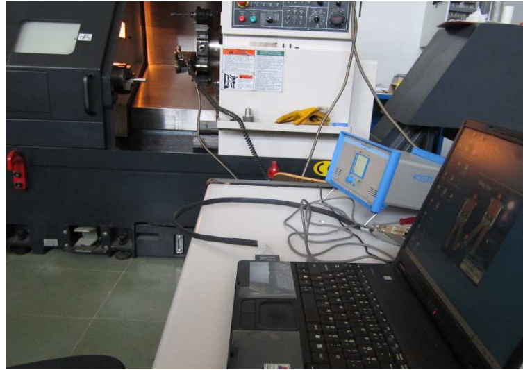
Şekil 5.9 Kesme kuvvetlerini ölçen dinamometrenin BSD torna tezgahına bağlanması
