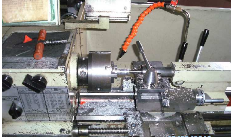
Şekil 5.5 Dökülen numunelerin dış yüzeylerinin talaş alma yoluyla temizlenmesi
