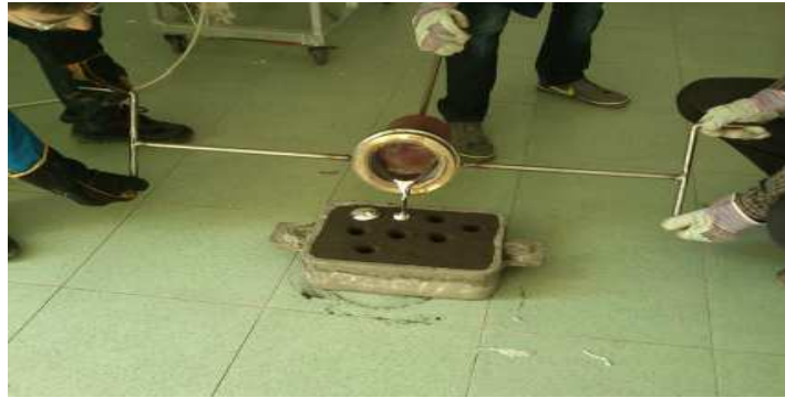
Şekil 5.3 Ergiyen kompozit metalin kum kalıba dökülmesi
