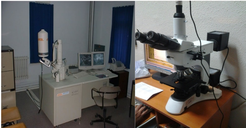
Şekil 4. 12 JEOL JSM-5600 elektron mikroskop ve optik mikroskop
