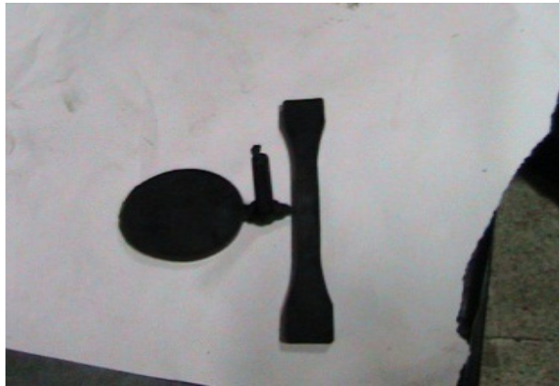
Şekil 4. 4 Kalıptan çıkan kompozit
