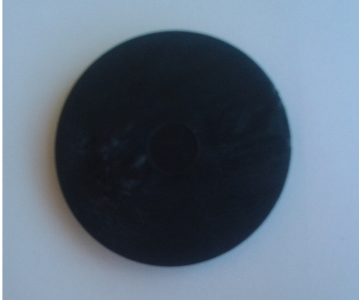
Şekil 4. 10 Sertlik ölçme testi deney numunesi
