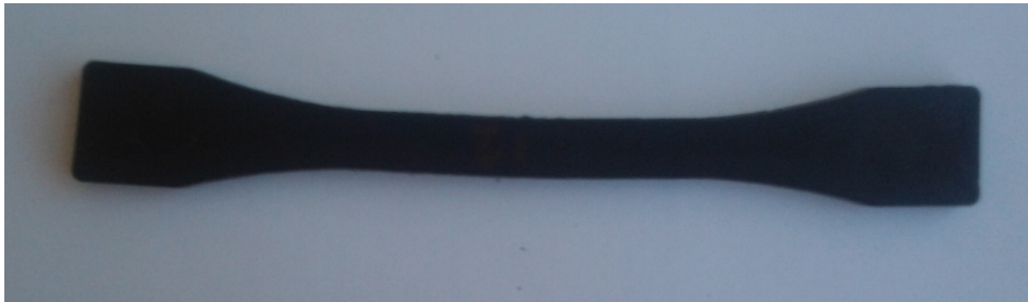
Şekil 4. 6 Çekme testi deney numunesi
