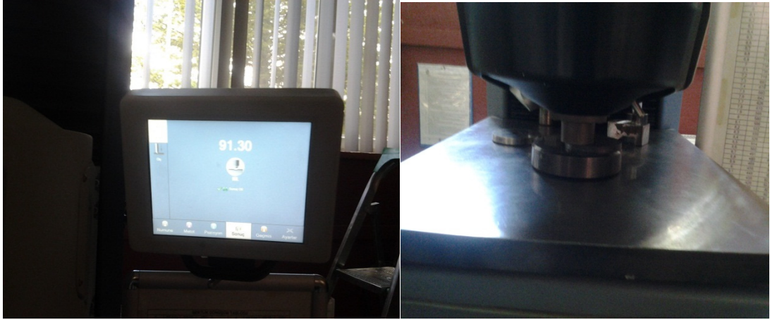
Şekil 4. 9 Emcotest HRL test cihazı
