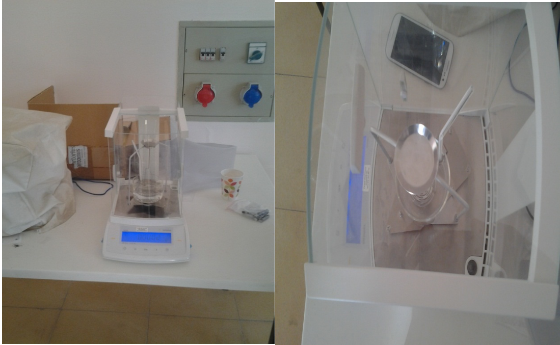
Şekil 4. 11 Sartoris CPA224S marka deney terazisi
