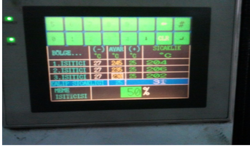
Şekil 4. 3 Plastik enjeksiyon makinasın kontrol sistemi
