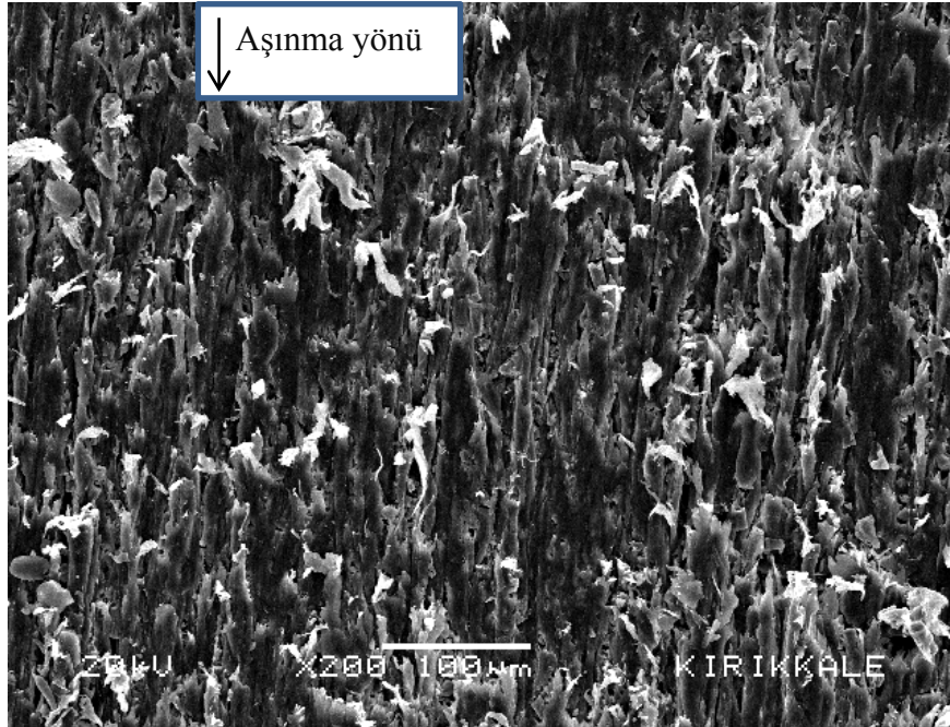
Şekil 5.20 %35 Cam elyaf ve %2 B 2 O 3 takviyeli kompozitin aşınma yüzeyi SEM görüntüsü
