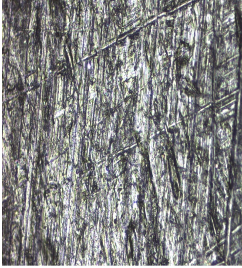
Şekil 5.26 %30 Cam elyaf ve %2 B 2 O 3 takviyeli kompozitin optik mikroskop görüntüsü A)20x büyütme B)50x büyütme
