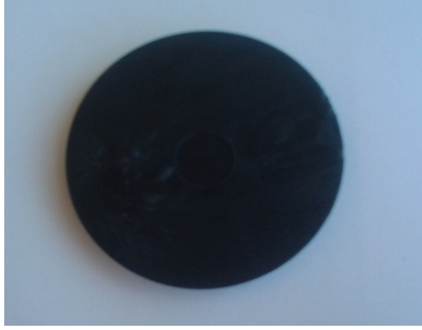
Şekil 4. 16 Isıl İletkenlik Testi Deney Numunesi
