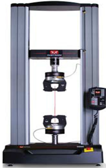
Şekil 4. 5 İnstron marka çekme testi deney cihazı
