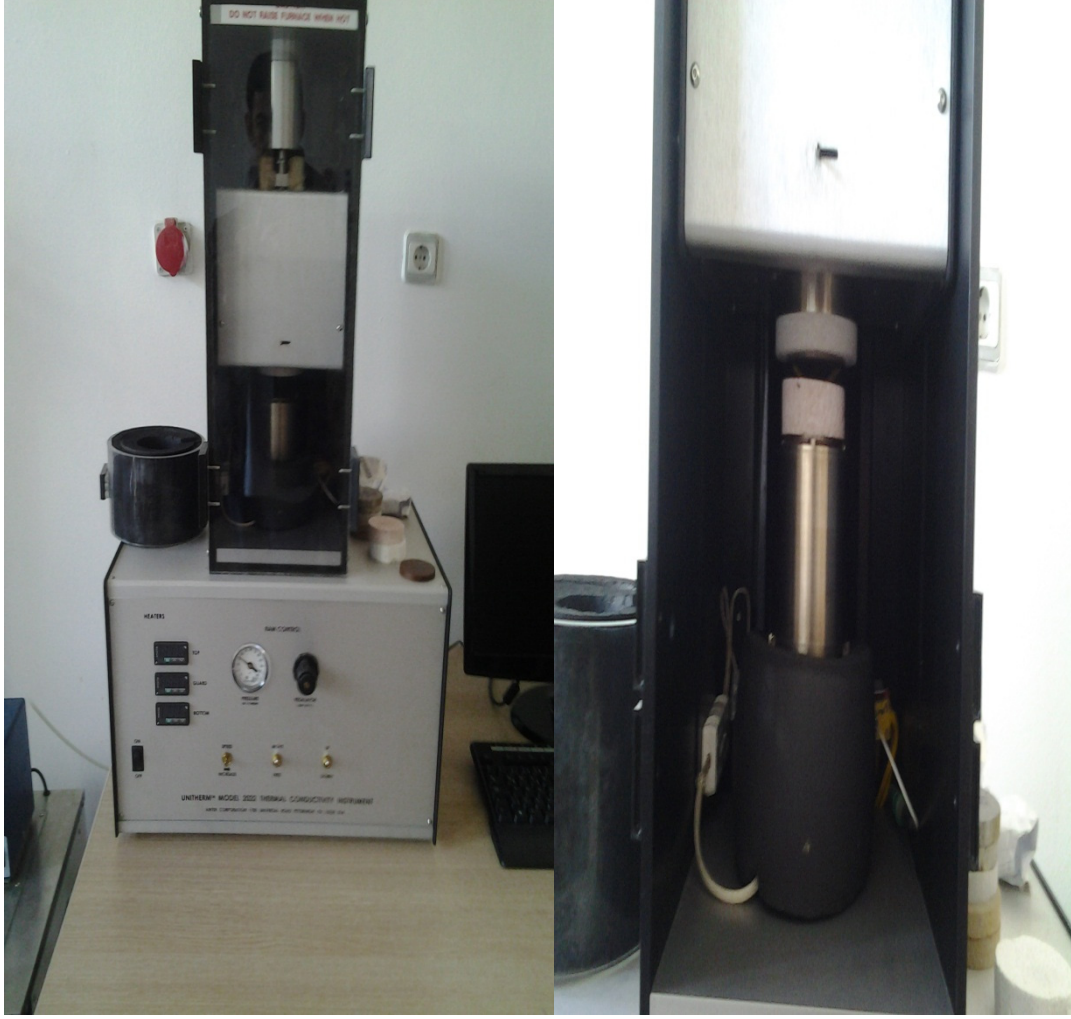
Şekil 4. 15 Anter Uniterm Model 2022 marka termal iletkenlik
