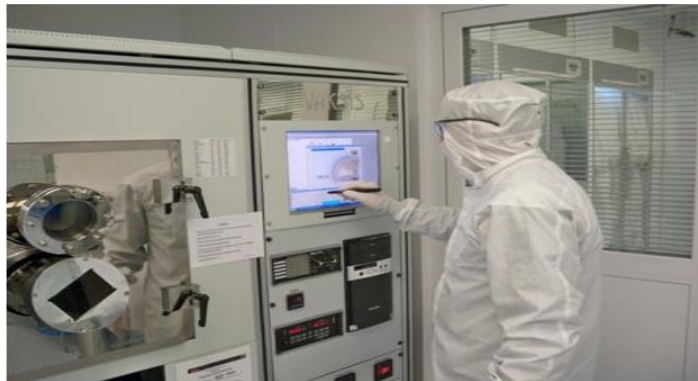
Şekil 2.1. Isısal buhar biriktirme sistemi (UNAM-Vaksis PVD Vapor – 3S)
