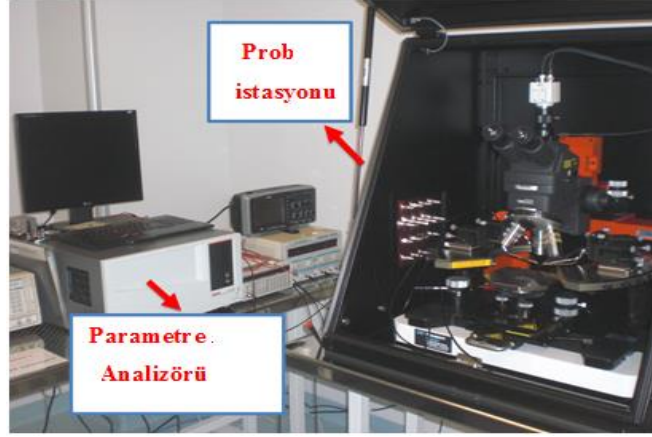
Şekil 3.8. UNAM temiz odada bulunan parametre analizörü ve prob istasyonu
