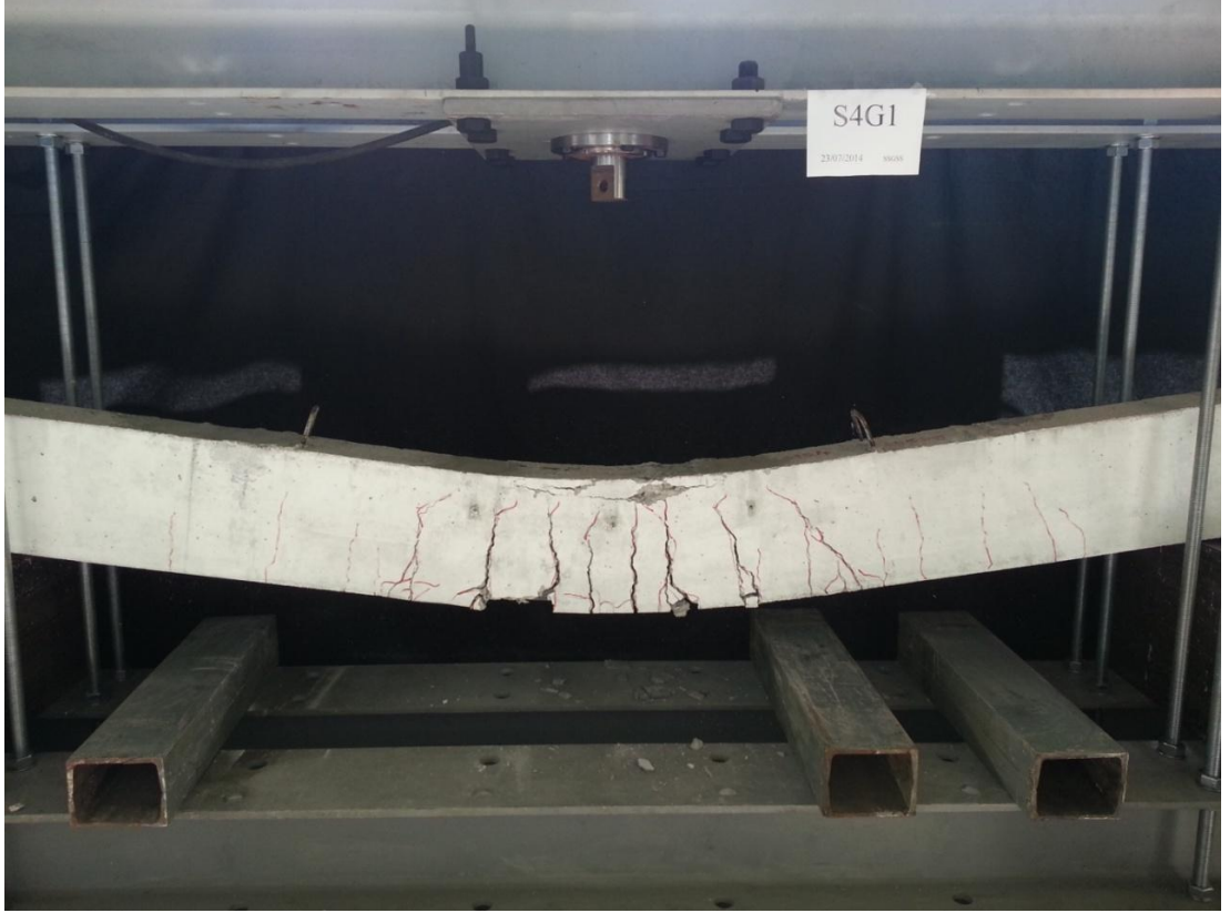
Şekil 2.18. S4G1 elemanında oluşan çatlak gelişimi
