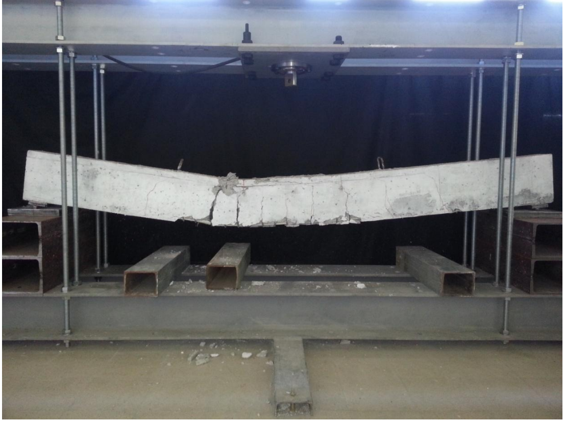
Şekil 2.35. S1G4 elemanın deney sonunda genel hasar durumu
