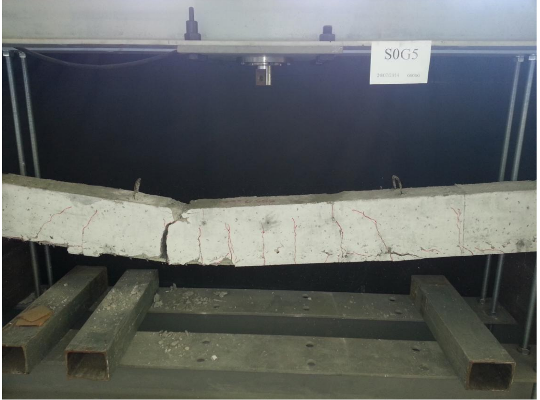
Şekil 2.38. S0G5 elemanında oluşan çatlak gelişimi
