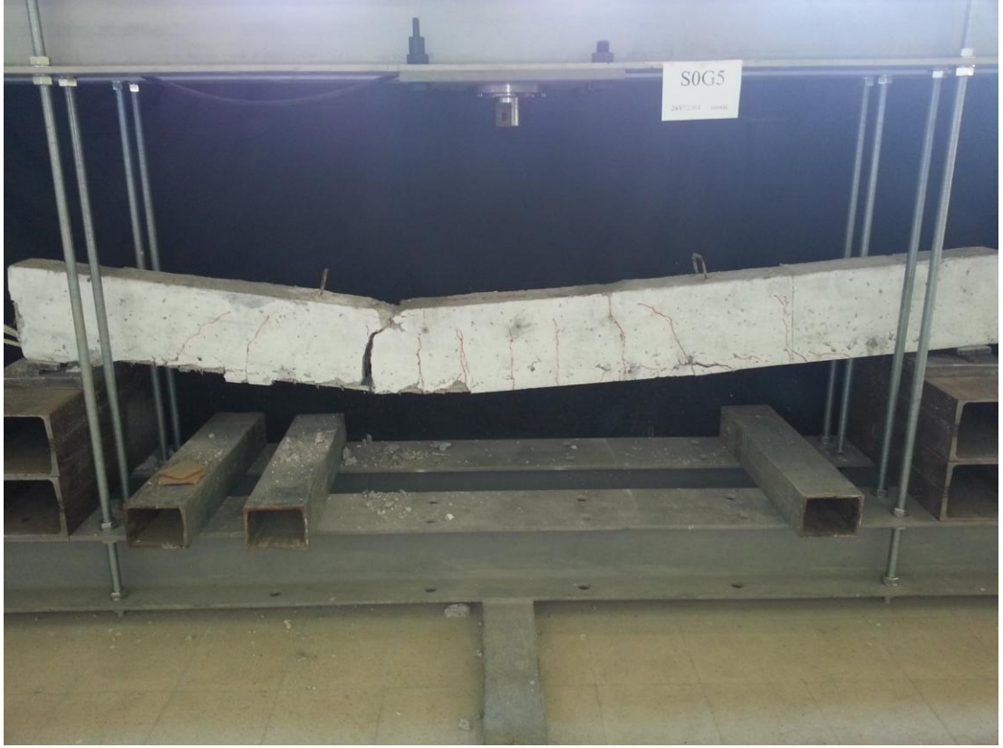
Şekil 2.39. S0G5 elemanının deney sonunda genel hasar durumu
