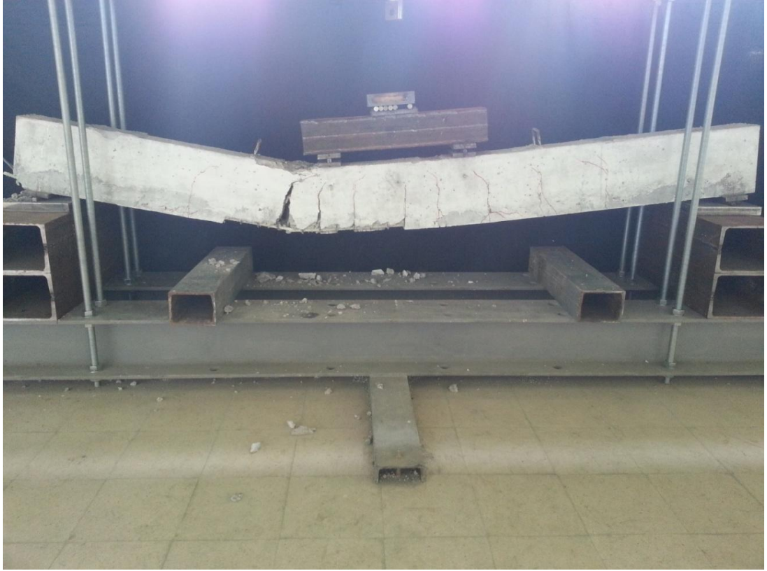
Şekil 2.31. S2G3 (GSGSG) elemanının deney sonunda genel hasar durumu
