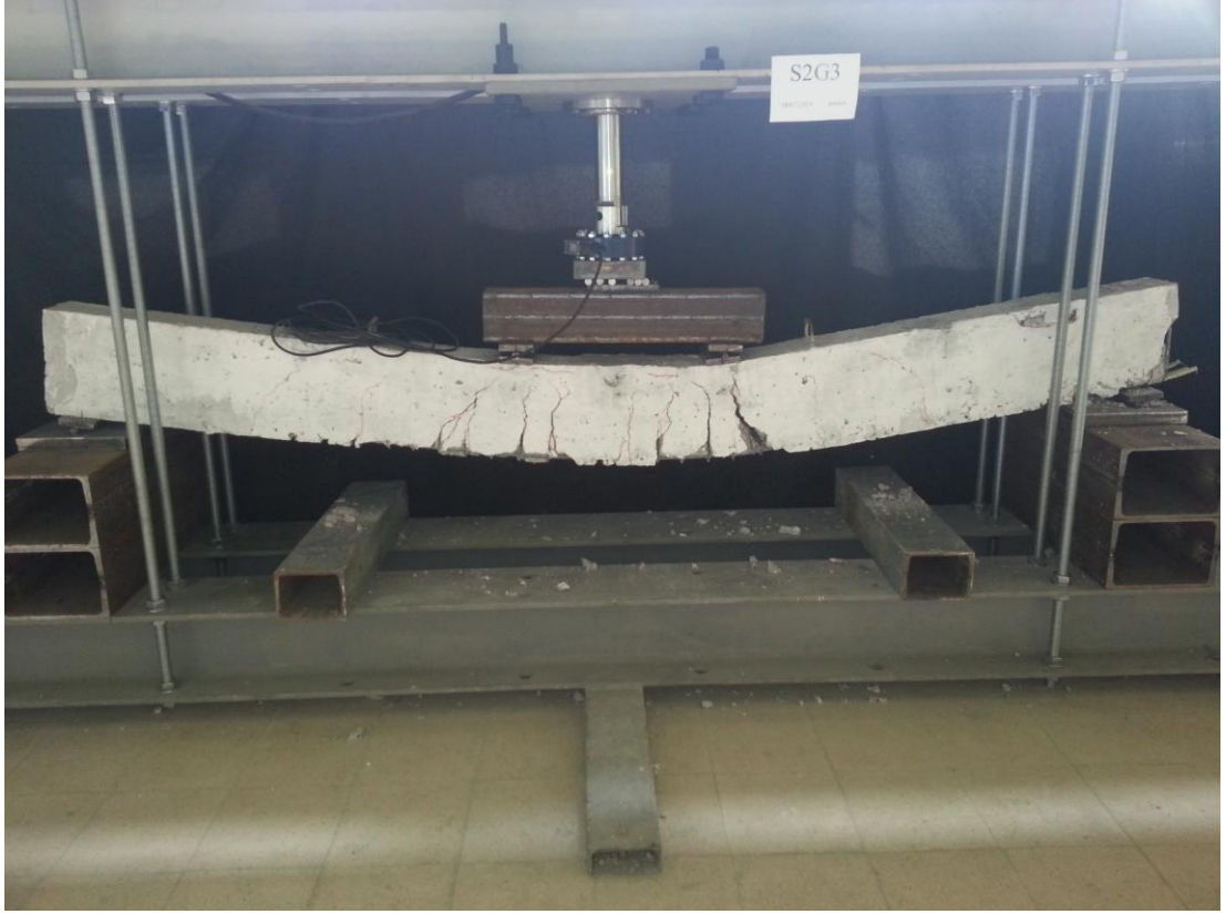
Şekil 2.27. S2G3 (SGGGS) elemanının deney sonunda genel hasar durumu
