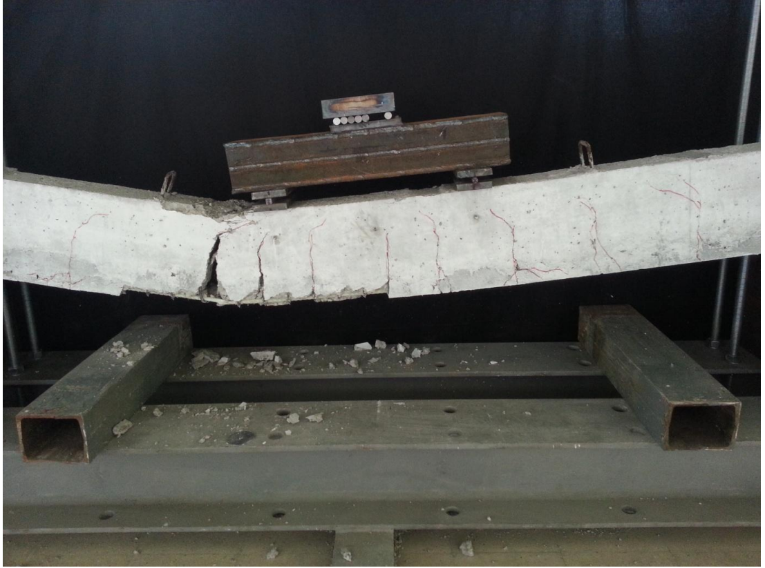
Şekil 2.30. S2G3 (GSGSG) elemanında oluşan çatlak gelişimi
