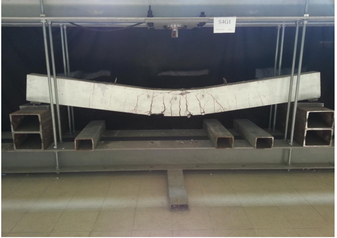
Şekil 2.19. S4G1 elemanının deney sonunda genel hasar durumu
