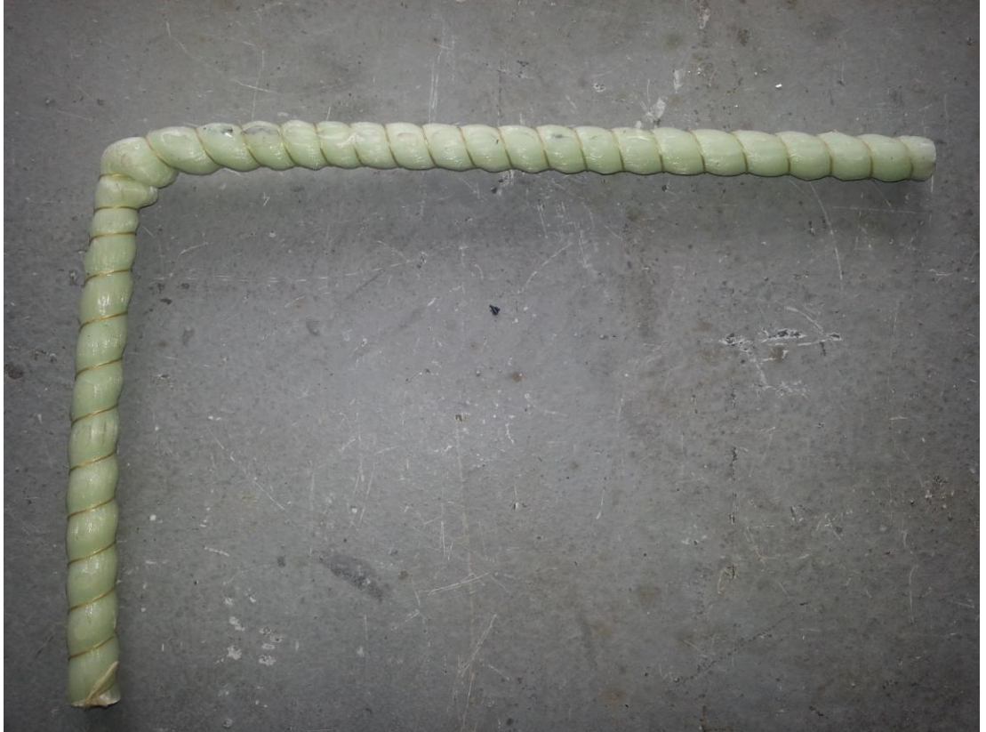
Şekil 2.5. Deney elemanlarında kullanılan GFRP donatı
