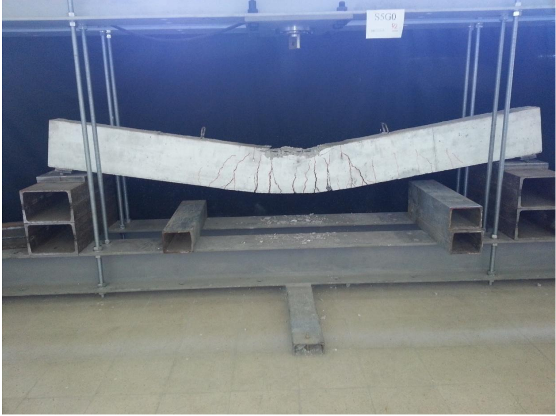
Şekil 2.15. S5G0 elemanın deney sonunda genel hasar durumu
