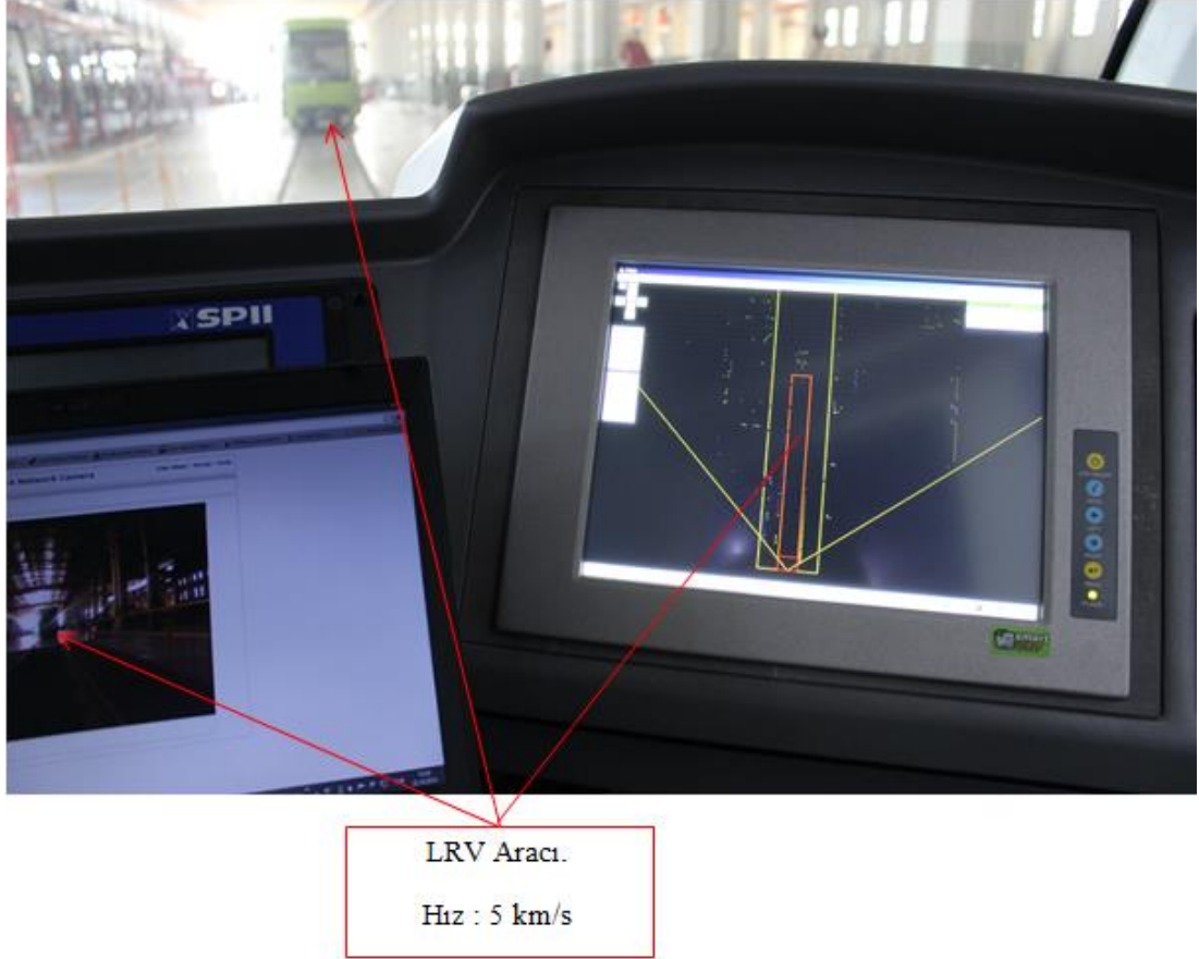
Şekil 4. 3. Hattaki aracın hızı V=5 km/s. iken(filtreleme hızına eşitken) ekran görüntüsü
