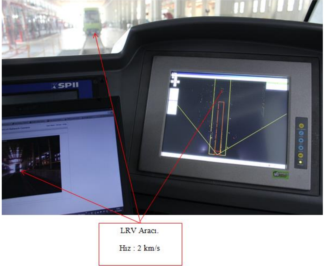
Şekil 4. 2. Hattaki aracın hızı V=2 km/s. iken(filtreleme hızının altında) ekran görüntüsü
