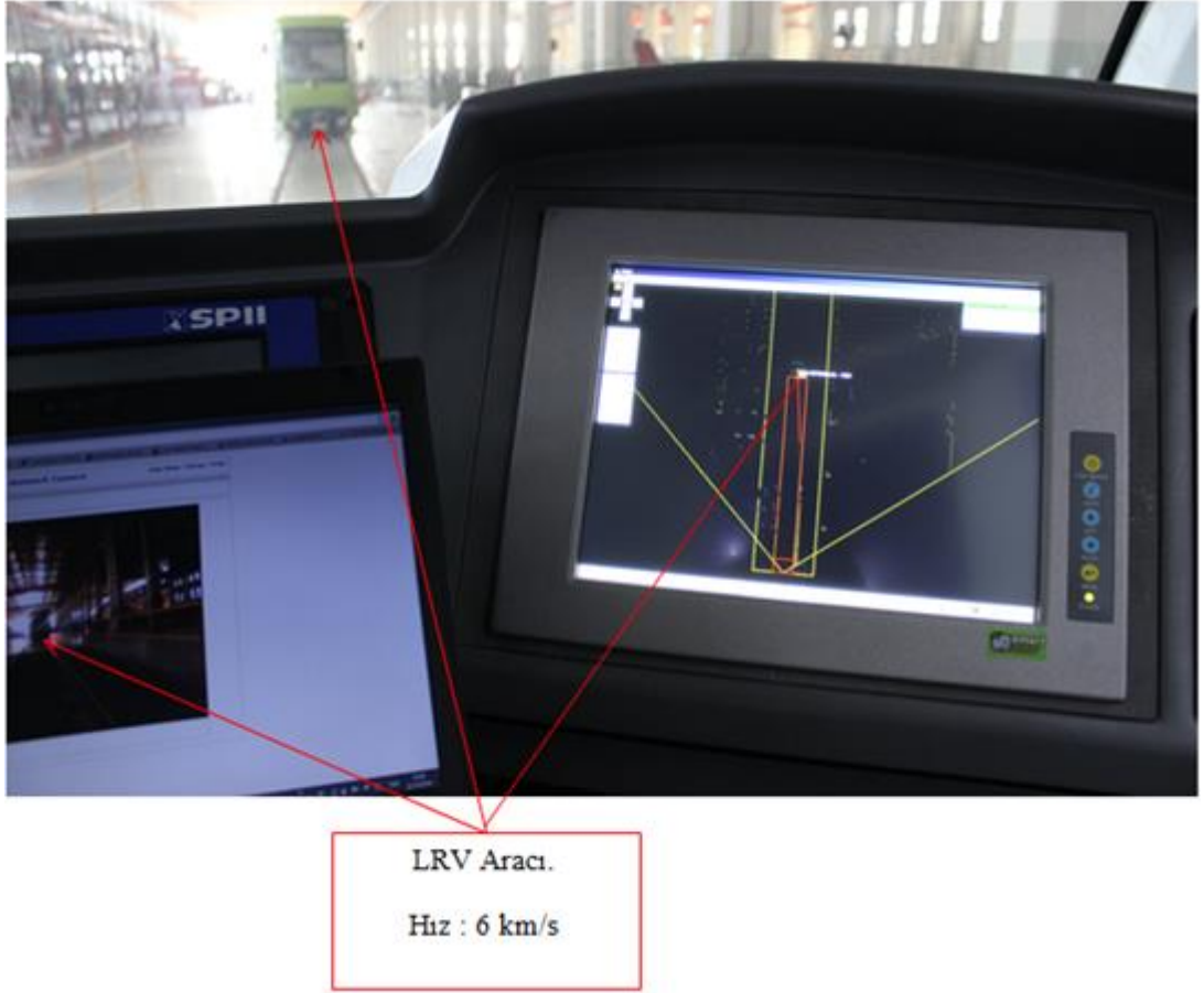
Şekil 4.4. Hattaki aracın hızı V=6 km/s. iken(filtreleme hızı aşıyor) ekran görüntüsü, uyarı zili çalıyor.
