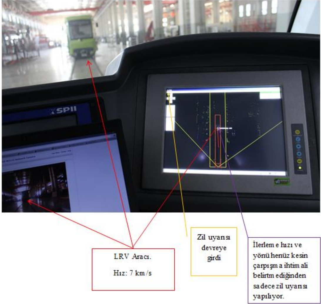
Şekil 4.5. Hattaki aracın hızı V=7 km/s. iken tehlikeli alanın içerisindeyken ekran görüntüsü, uyarı zili çalmaya devam ediyor.
