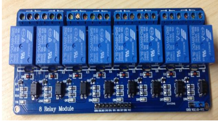
Şekil 2.5. 8 kanallı röle seti
