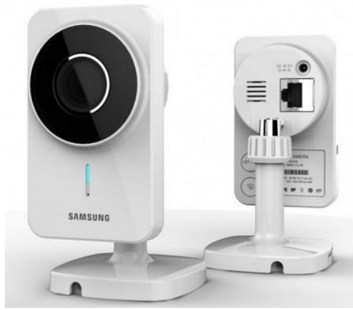
Şekil 2.21. Bir IP kameranın ön ve arkadan görünüşü
