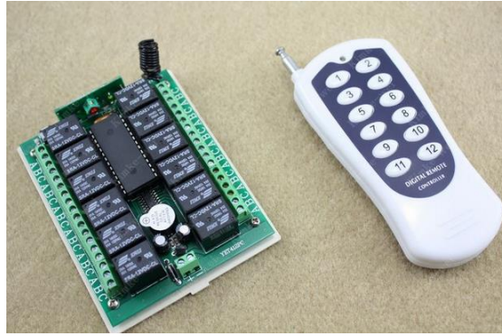
Şekil 1.1. 12 kanallı bir kablosuz uzaktan kumanda verici ve alıcı sistemi
