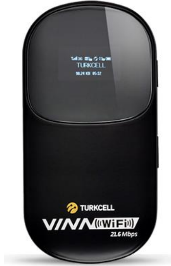
Şekil 2.22. Projede İnternet erişimi için kullandığım bir 3G – WiFi gateway cihazı
