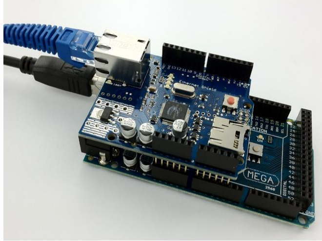
Şekil 2.4. Arduino Mega üzerine takılı bir Ethernet modülü, Arduino USB kablosu ile PC'ye, Ethernet modülü Ethernet kablosu ile yerel ağa bağlı durum
