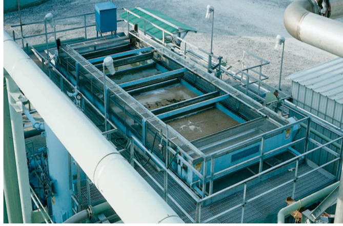
Şekil 1.16. Endüstriyel flotasyon işlemi [41]
