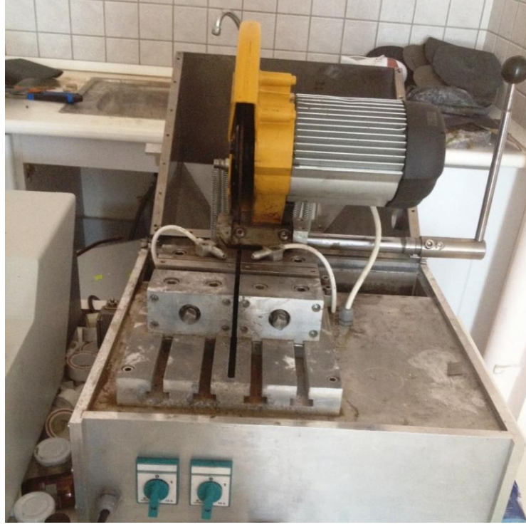
Şekil 3.4. Çelik örnekleme kesmek için kullanılan kesicinin görüntüsü
