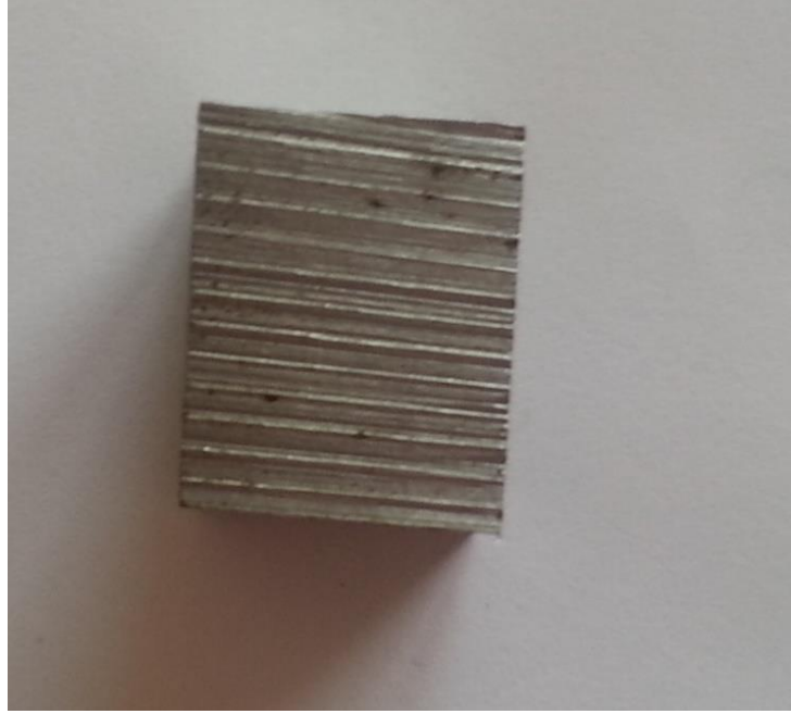
Şekil 3.5. Kesme işlemi sonucunda elde edilmiş örneklem görüntüsü, üzerinde paralel çizgi şeklinde oluşmuş yapılar kesici bıçaktan dolayı kaynaklanmıştır.
