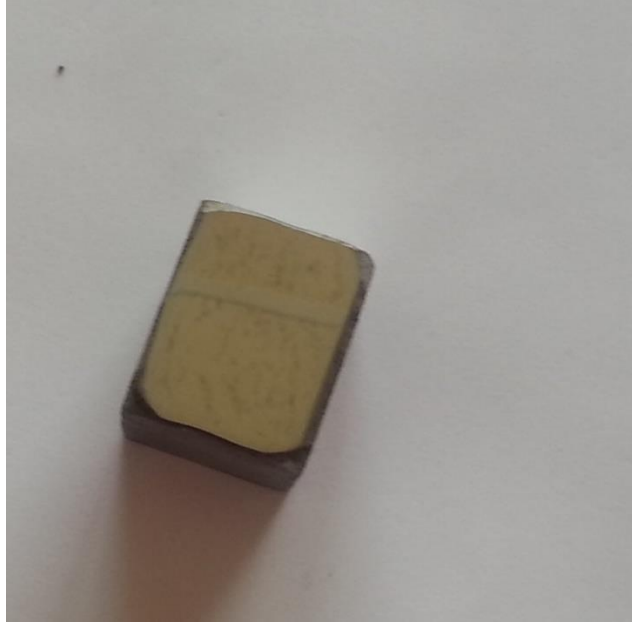
Şekil 3.7. Analiz için zımparalama ve parlatma işlemlerinden geçirilerek hazır hale getirilmiş örneklemin görüntüsü.
