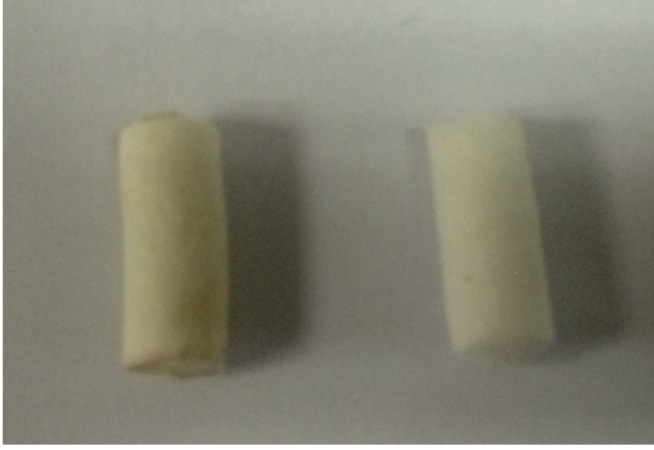
Şekil 1.11. Monolitik kriyojellerin optik fotoğrafı.
