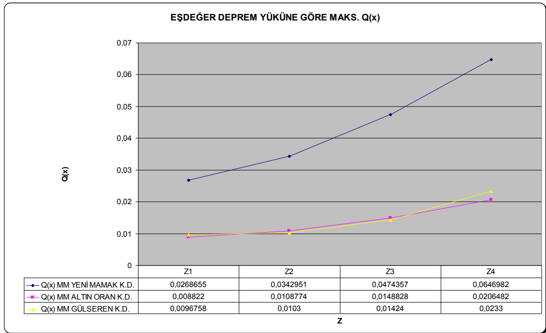
Şekil 3.33. Üç Projenin Eş Değer Deprem Yükü Analizleri x yönünde Max Yanal Ötelenme (Qx ) Sonuçlarının Karşılaştırılması
