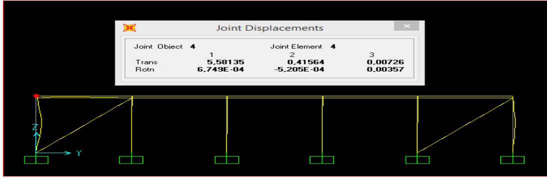
Şekil 4.16. Bağlantı Elemanı 2L70x7/10/ Olan Sistemin Y Yönündeki Rüzgar Yükü İle Yatay Ötelenmesi(mm)
