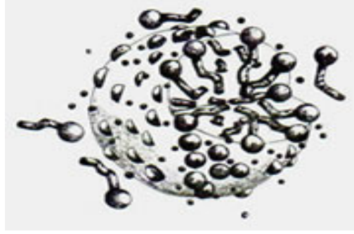
Şekil 1.2. Mikroemülsiyonlar oluşturan sürfektanlar [10]
