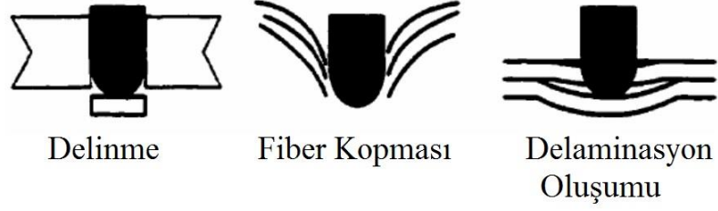
Şekil 2.28. Darbe Sonucu Hasar Oluşumları [97]
