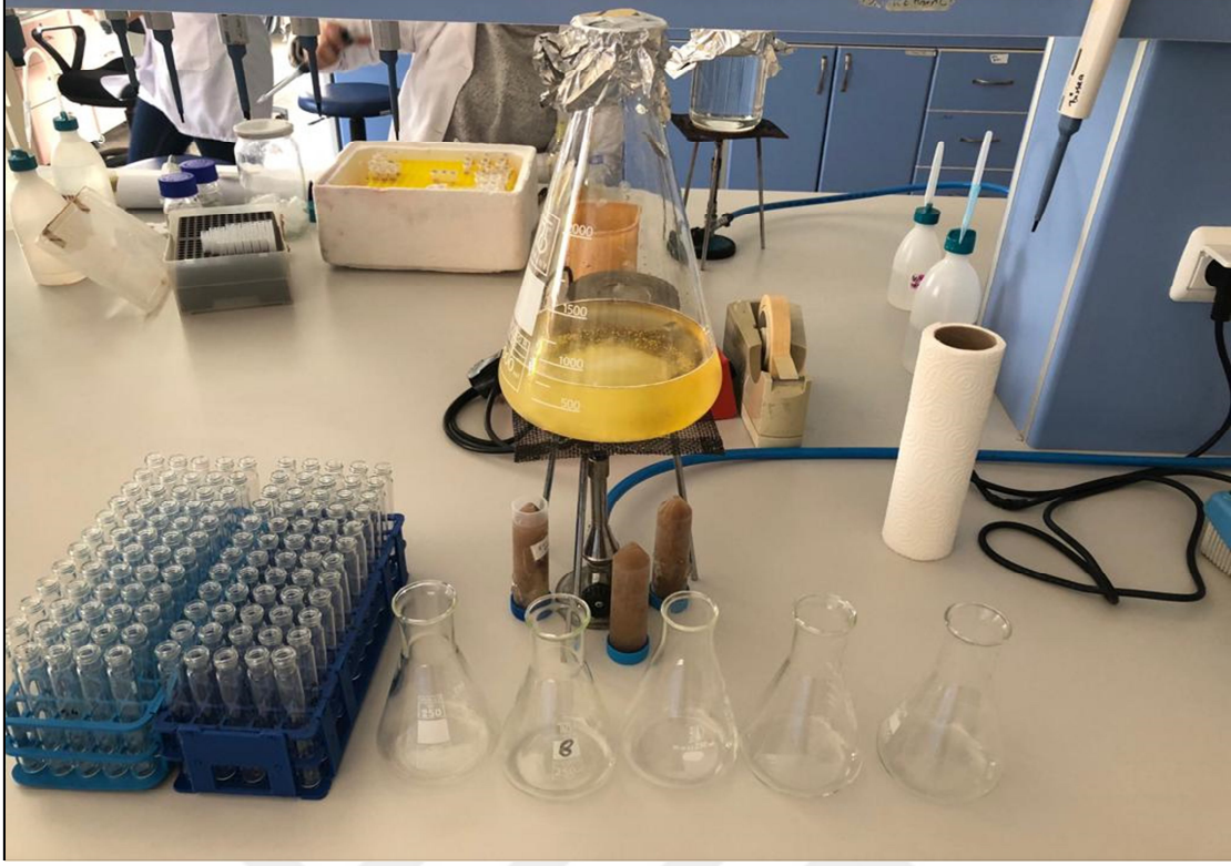
Şekil 4.4. Erlenmayer şişelerine dağıtılarak 5 farklı şekilde pH düzeyi ayarlanacak enerji kaynağı glikozlu kullanılan besiyeri çözeltisi
