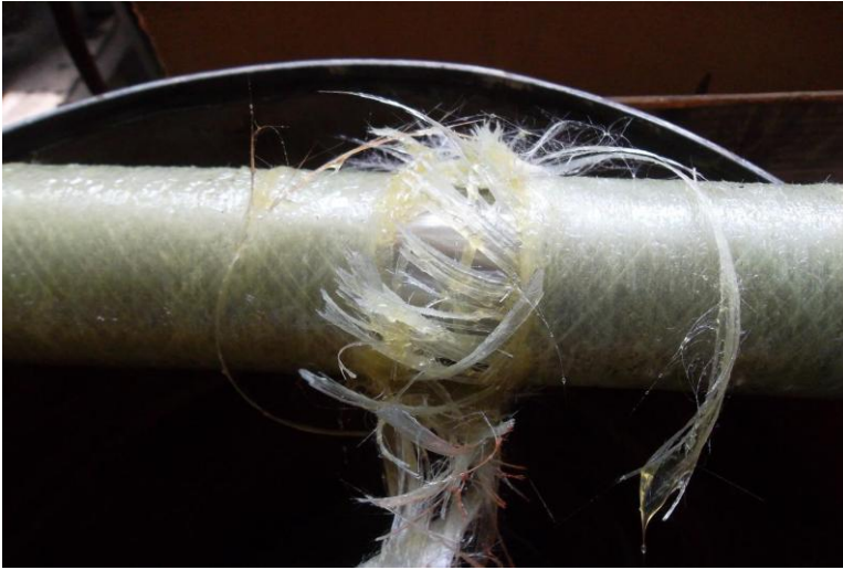
Şekil 3.8. Basınca maruz kalan kompozit sargılı borunun hasarı
