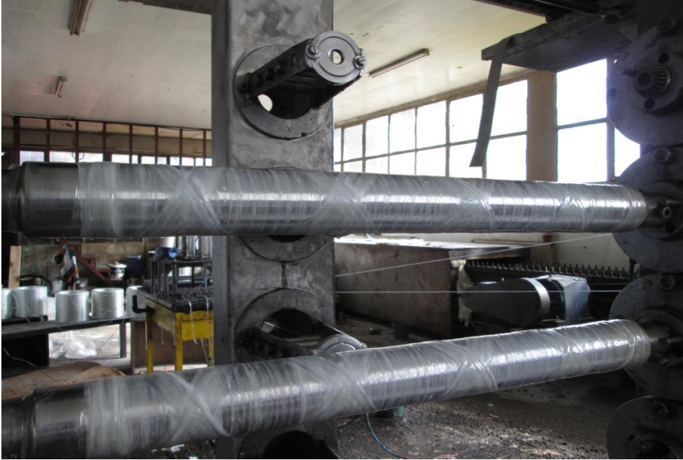
Şekil 3.2. İstenilen açılarda sarımın yapılması
