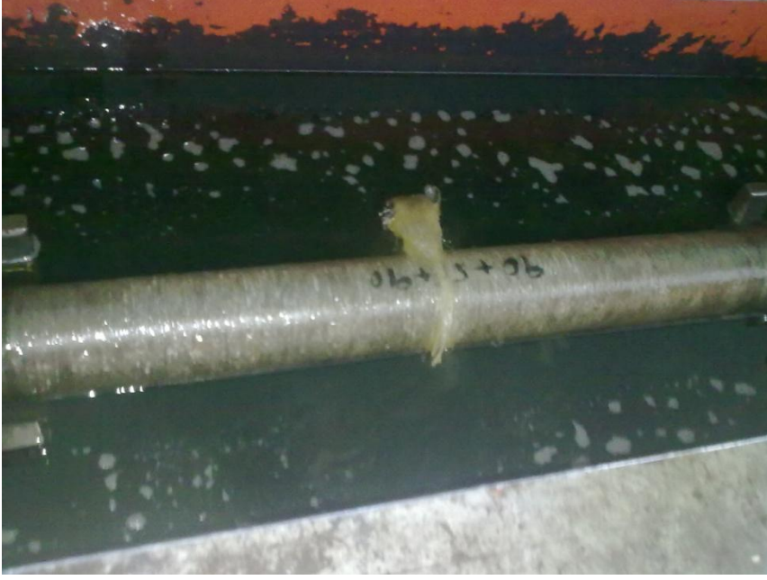
Şekil 3.5. PLC kontrollü, hidrolik test cihazına bağlı olan kompozit boru
