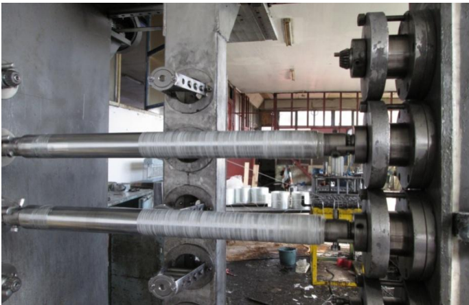
Şekil 1.20. CNC Flaman sarım makinesi ile teğetsel sarım işlemi
