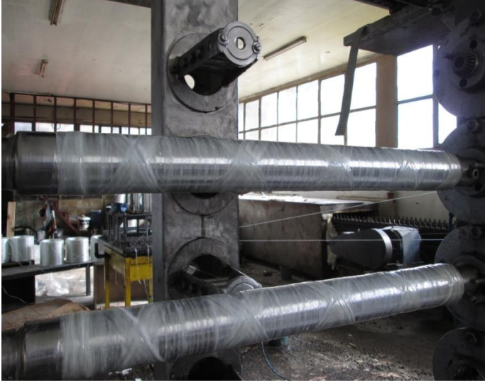
Şekil 1.19. CNC Flaman sarım makinesi ile helisel sarım
