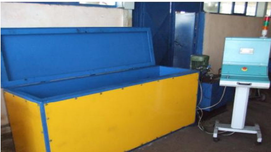
Şekil 3.4. PLC kontrollü, servo motorlu hidrolik test cihazı
