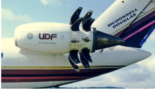
Şekil 1.12. Propfan motoru ve çevrim şeması
