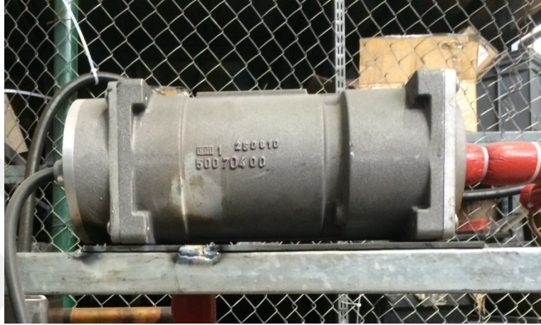
Şekil 4.6. Türbin olarak kullanılan spiral kompresörün fotoğrafı.
