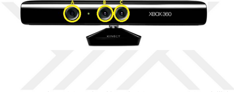
Şekil 1.11 Kinect: (A) Kızılötesi kaynak, (B) 2B Kamera, (C) Derinlik kamerası [11].
