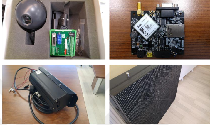
Şekil 2. 6. Kamera, radar, GPRS ve VMS ekipmanları
