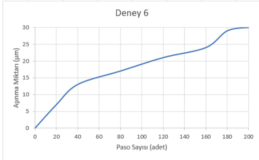
Şekil 5.12. Deney 6'ya ait takım aşınma miktarı grafiği
