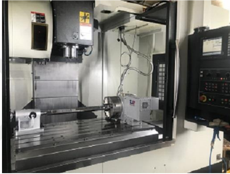
Şekil 4.1. CNC dik işlem merkezi ve deney düzeneği
