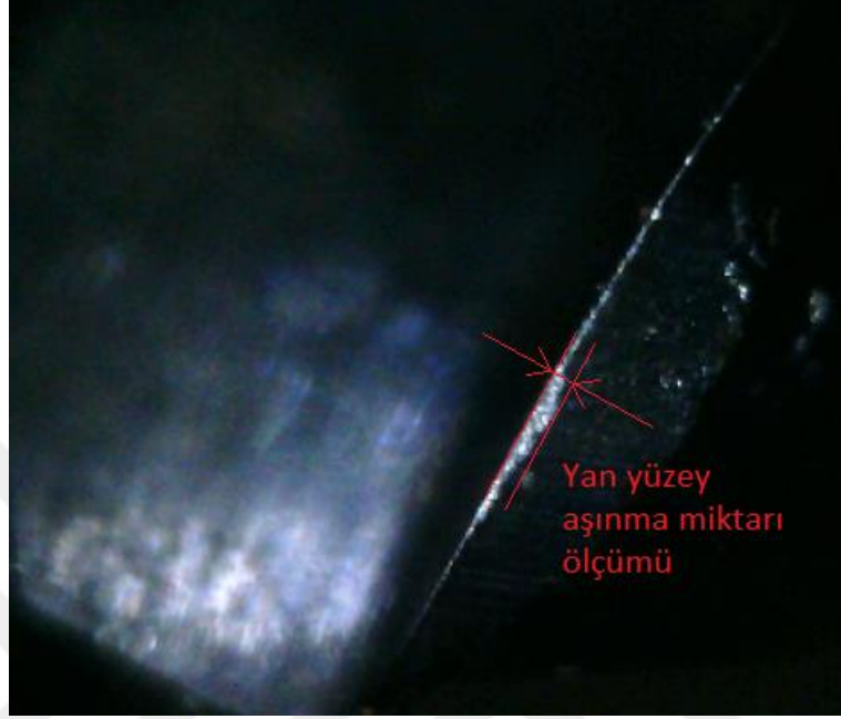
Şekil 4.8. Dijital mikroskopla elde edilen küresel takımın kesici ucuna ait bir görüntü ve yan yüzey aşınma miktarı ölçümü
