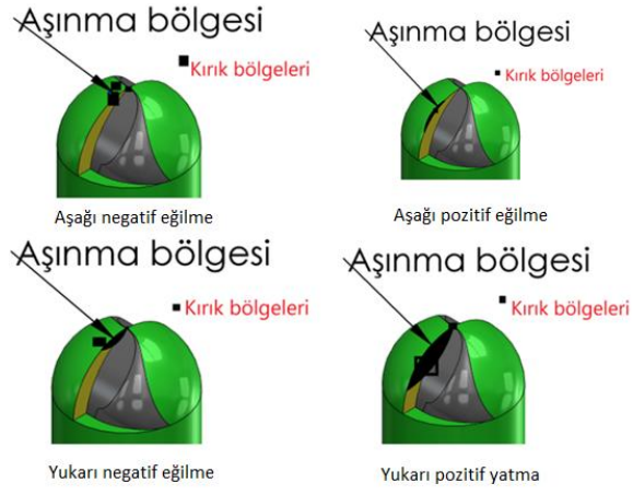
Şekil 5.24. Takımın aşınma ve kırılma bölgelerinin sembolik olarak gösterimi
