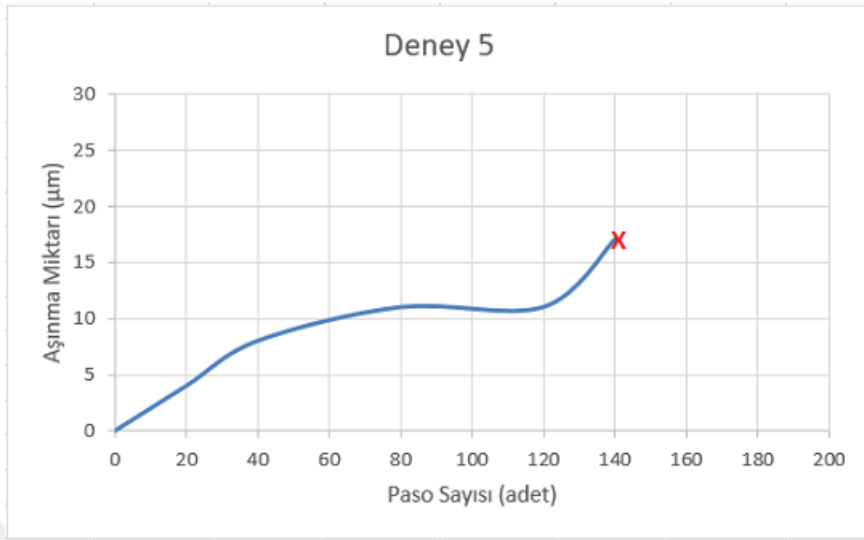
Şekil 5.10. Deney 5’e ait takım aşınma miktarı grafiği
