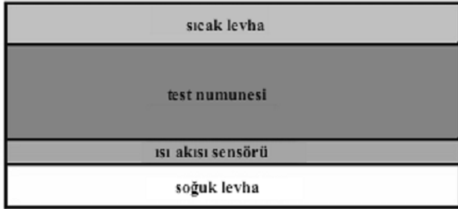
Şekil 3.5. Isı akış metre metoduna göre ölçüm yapan deney cihazı şematik görünüşü
