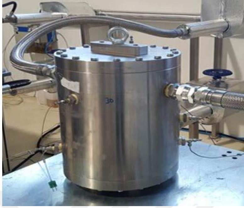
Şekil 2. 1. Labirent keçe kaçak debi ölçümü için test düzeneği [30]
