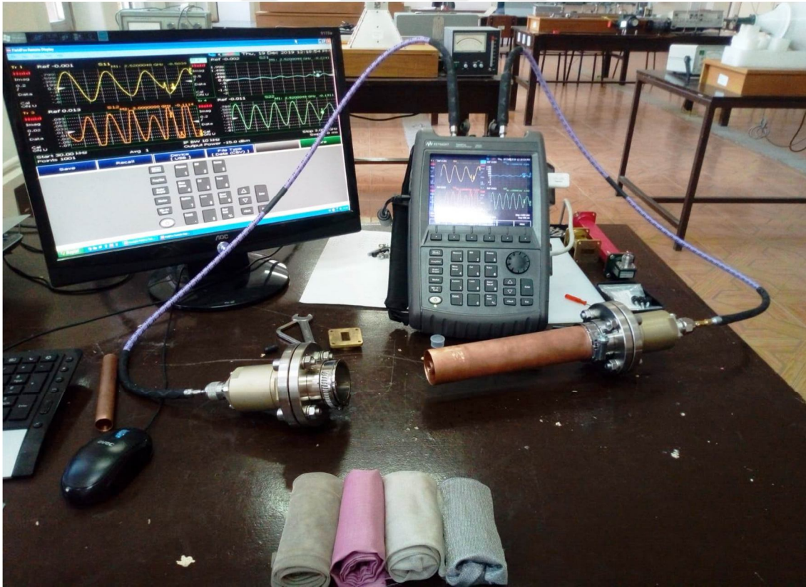
Şekil 3.1. N9918A FieldFox Taşınabilir Mikrodalga Vektör Network Analizörü
