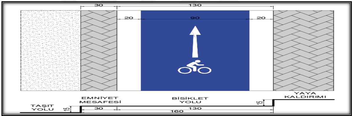
Şekil 4.37. Dar Yaya Kaldırımında Tek Şeritli Bisiklet Yolu (Daraltılmış Emniyet Mesafesi) (ÇŞB, 2015)
