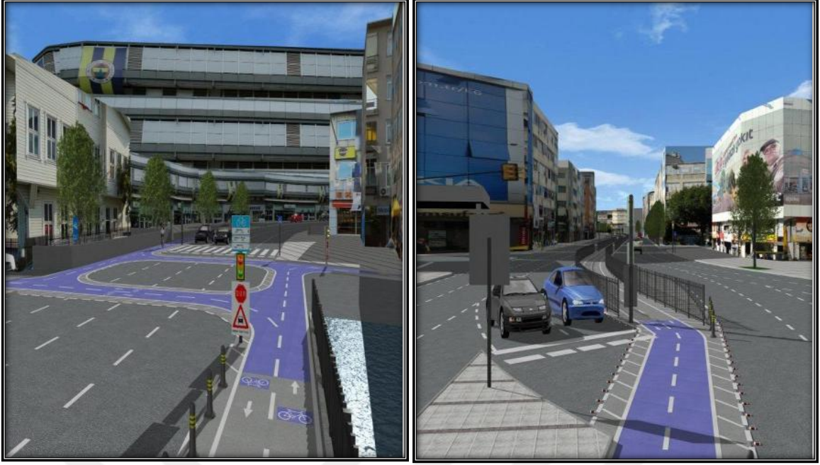
Şekil 2.10.Doğru planlanmış kavşak geçişleri, yol ayrımları ile yol güvenliği sağlanmış bisiklet yolu
