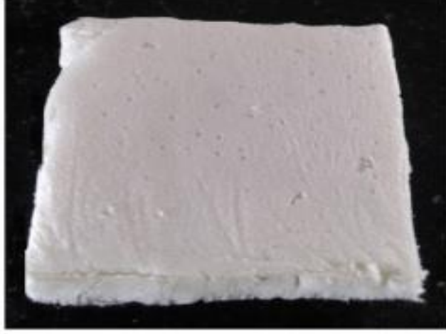
Şekil 0.4 Dondurarak kurutma yöntemi ile hazırlanan Keratin kompozit yapı iskelesi (Kakkar ve ark. 2014).
