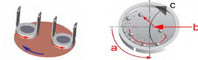
Şekil 3.9. Öğütme haznesinin ve bilyelerin hareketi
