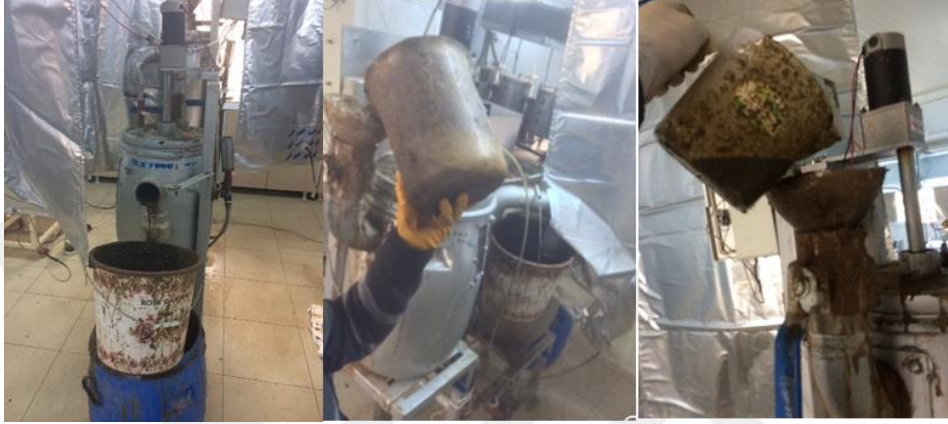
Şekil 3.33. CSTR reaktörlerine materyallerin yüklenmesi
