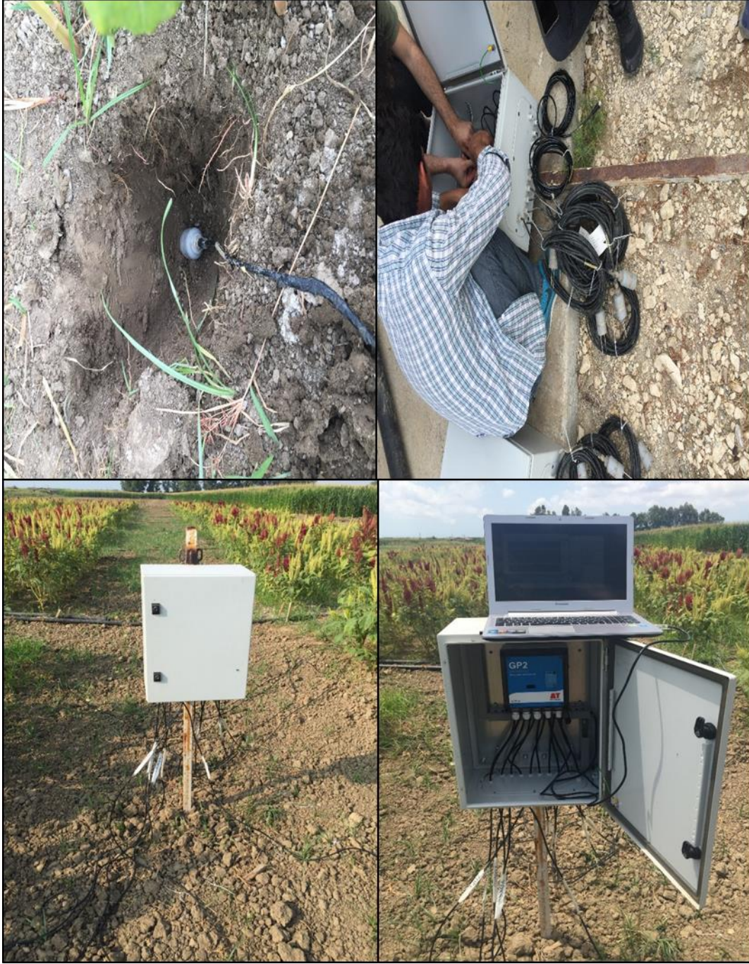
Şekil 3.8. Toprak nem sensörlerinin yerleştirilmesi ve verilerin data loggerda derlenmesi
