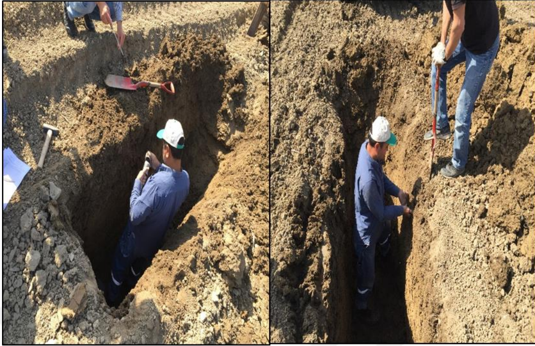
Şekil 3.3. Araziyi temsil eden noktalardan toprak örneklerinin alınması
