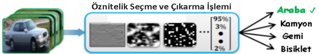
Şekil 2.31. Konvolüsyon katmanı öznitelik seçme ve çıkarma işlemi [87]
